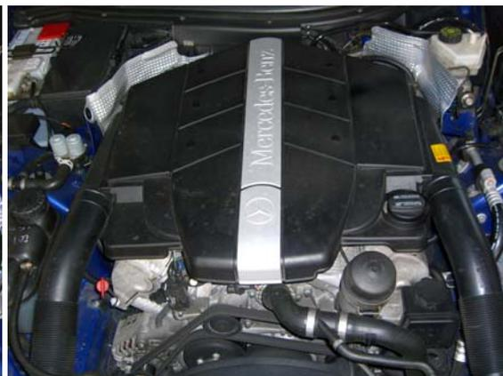
**11. Luftansaugrohre und Luftfilter/Motor-Abdeckung wieder aufsetzen ...**
