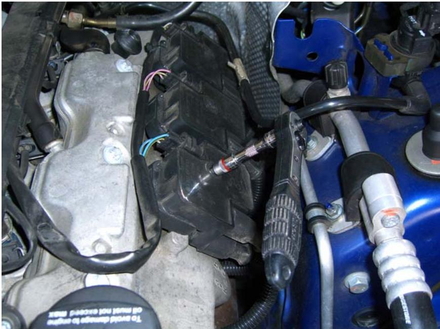
**4. Mit Torx T30 alle 6 Zündspulen runter schrauben.**
