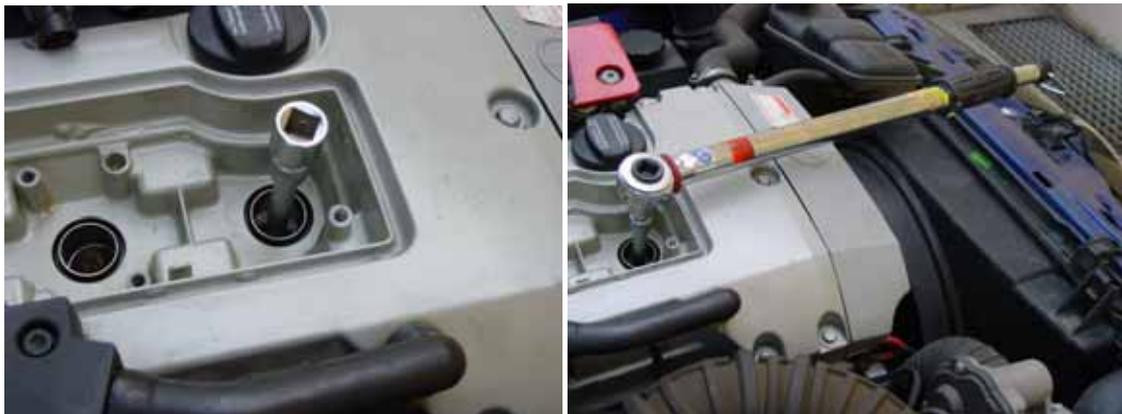
Bei den anderen Zündkerzen wiederholen. Zündanlage und Deckel in umgekehrter Reihenfolge wieder montieren.
