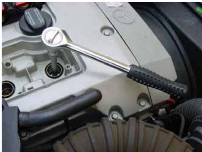
5) Alte Zündkerze entnehmen und Neue einbauen. Bei dem Original DC Schlüssel schnappt die Zündkerze richtig in den Schlüssel ein. So kann man sehr einfach die Kerze entnehmen und auch wieder montieren
