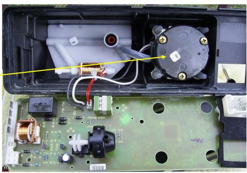
Ich vermutete, dass das Lager des kleinen Elektromotors an der Pumpe evtl. fest saß, weil nichts geschah. Daraufhin lötete ich diese beiden Kabel aus der Platine raus, legte wieder Spannung an, Polarität ist egal, und siehe da, die Pumpe arbeitete. Also muss der Fehler auf oder in der Platine in der elektronischen Schaltung liegen.
