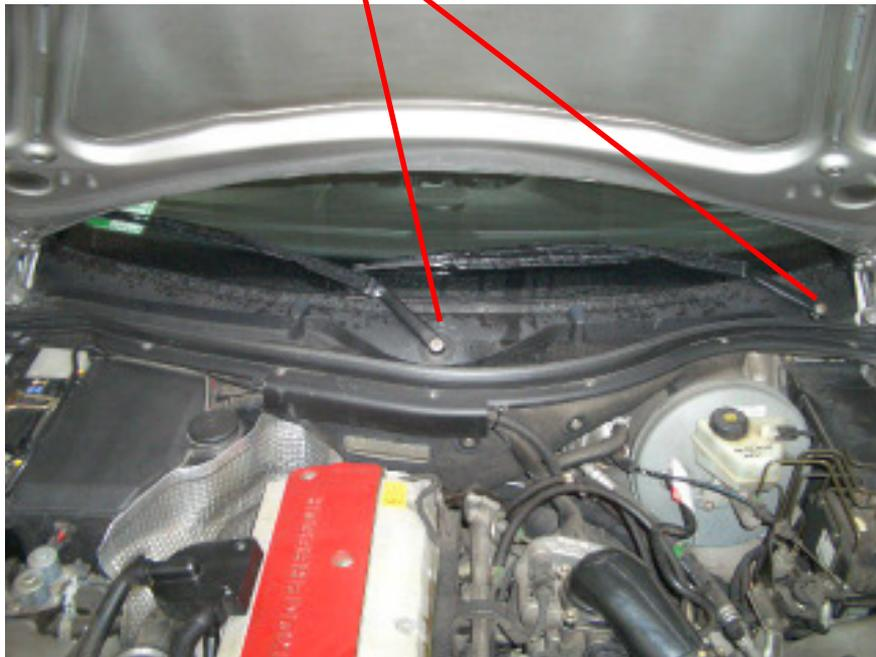
Hier ist eigentlich ein 2-Arm-Abstreifer gefragt. Sollte der nicht vorhanden sein, muss es mit etwas Gefühl und ein wenig Gewalt gehen. Dabei darauf achten, die Scheibe heile zu lassen! Anschließend die Kunststoff-Abdeckung vorsichtig anheben/abziehen. An der Unterseite der Abdeckung ist eine elektrische Leitung und der Wasserschlauch für die Frontscheibenreinigung. Den Wasserschlauch habe ich nicht abgeklemmt, wohl aber das Kabel (siehe unten)
