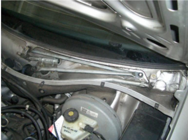
Danach den Motor wieder in den Rahmen einbauen und die gesamte Mimik wieder in die dafür vorgesehene Mulde schrauben (3 Schrauben).
