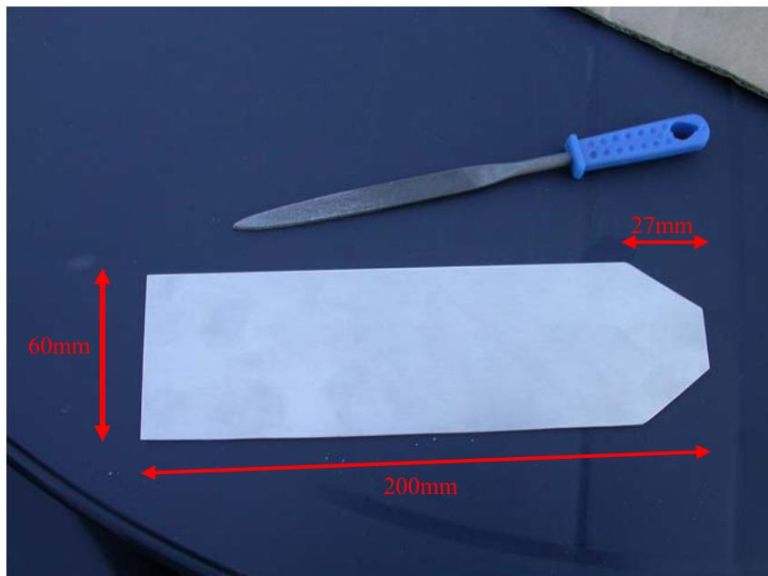
Da Alu sehr empfindlich ist, sollte man während der Bearbeitung immer ein Tuch unterlegen, damit es keine Kratzer gibt. Die beim Sägen sichtbare Seite des Blechs wird nachher die Unterseite, da die Stichsäge Rillen hinterlässt.
