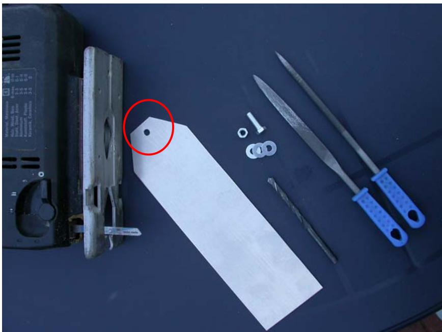
Die Kanten und das Loch sollte man mit einer Feile bearbeiten, da diese sehr scharf sein können. Eine flache und eine runde Feile sind hier sehr hilfreich (siehe Foto).
