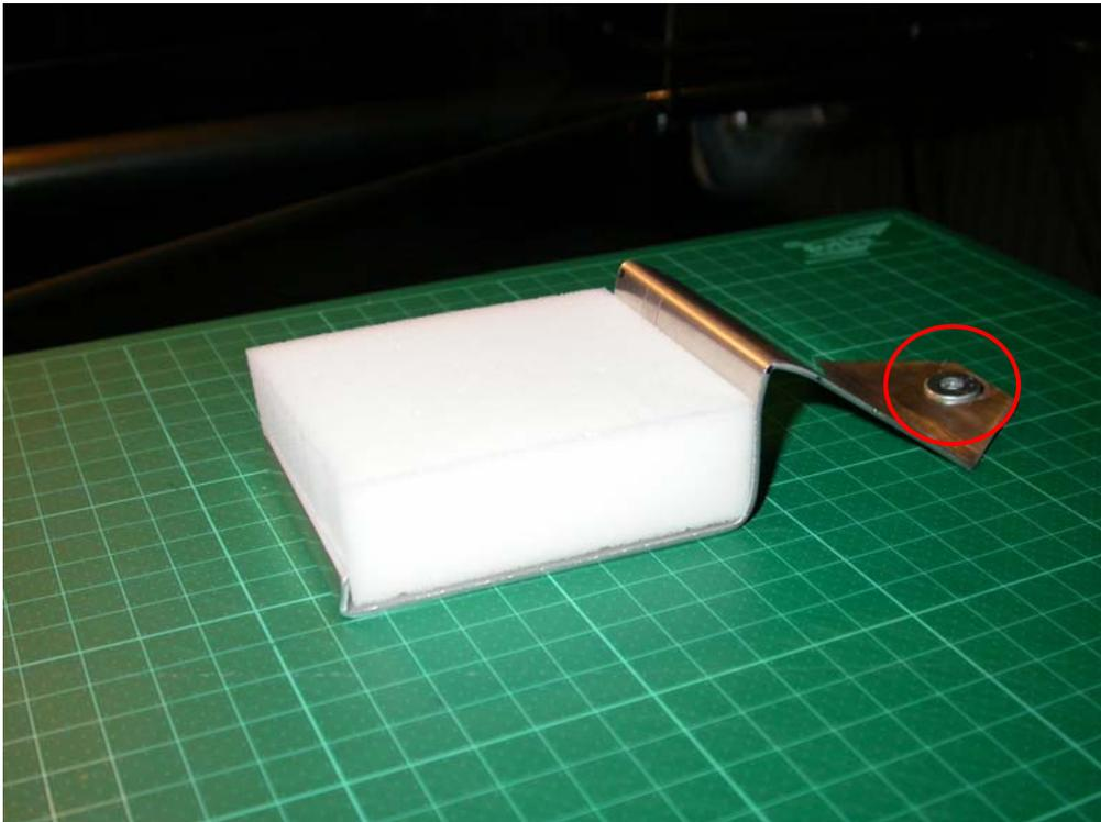
Im nächsten Schritt klebt man von unten am besten dünnen Filz oder etwas Ähnliches an die Stelle, auf der der Halter auf der Frontseite der Schublade bzw. Cupholders aufliegt, damit keine Kratzer entstehen. Dann das Endstück der Saugnapfhalterung des TomTom One mit Hilfe der Sechskantschraube, der dritten Unterlegscheibe und der Mutter mit Gummiring befestigen:
