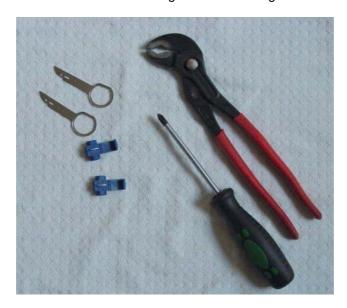
Haken zur Demontage des Radios (hier DC-Radio)
