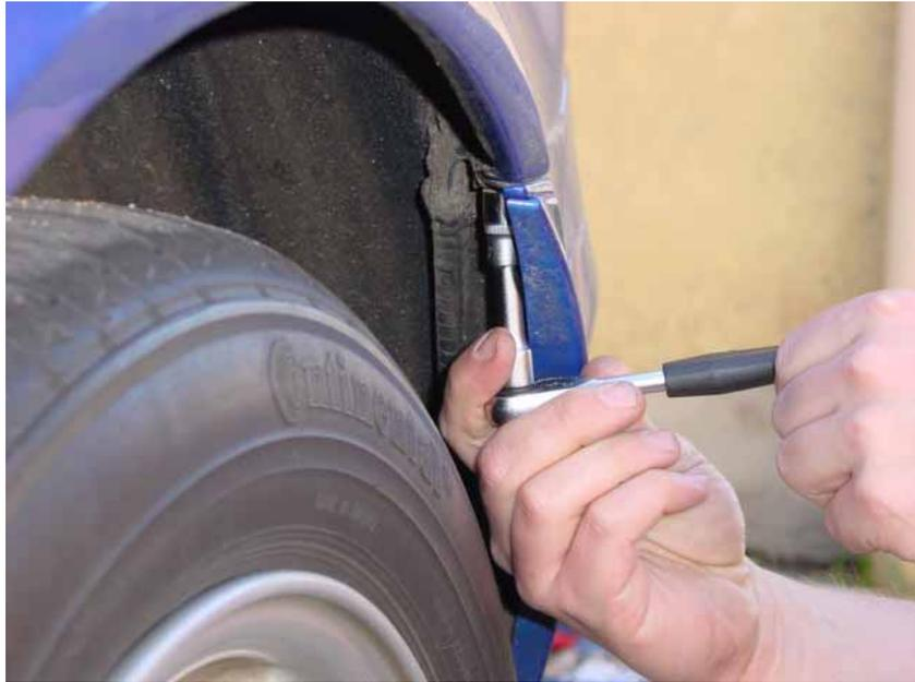
Dann Schraube Nr 3 lösen. Sieht man von hinten neben dem Rückfahrscheinwerfer. Ist auch mit einer 10er Nuss zu lösen
