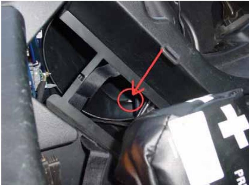
Dann Schraube Nr.2 im Radkasten lösen. Mit Maul oder Ringschlüssel Schraube von oben halten und von unten mit der Knarre lösen
