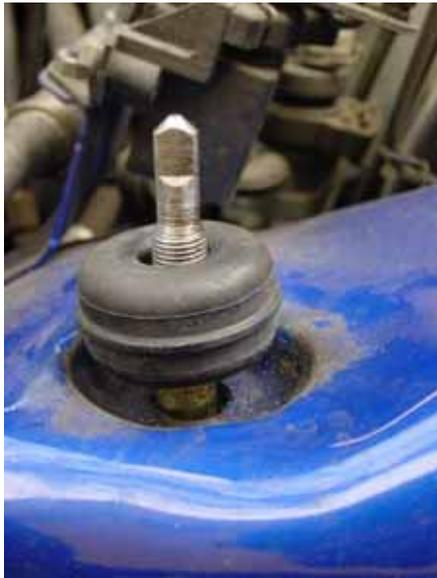
Den neuen Gummidämpfer einsetzen,
