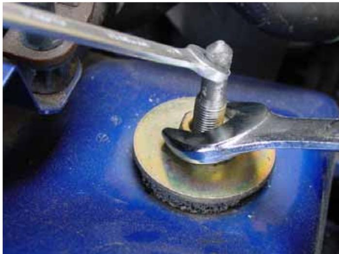
Mutter des Stoßdämpfers an den Vorderbau mit 18nM festziehen,
