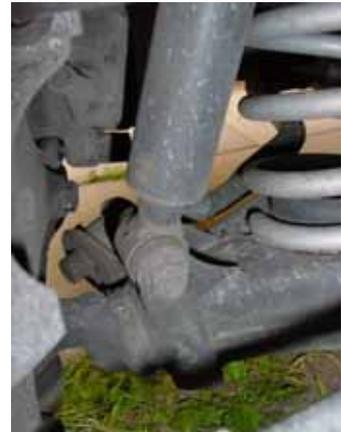
Die Schraube auf der einen Seite mit dem 17er Gabelschlüssel halten und auf der anderen Seite mit der Knarre die Mutter lösen
