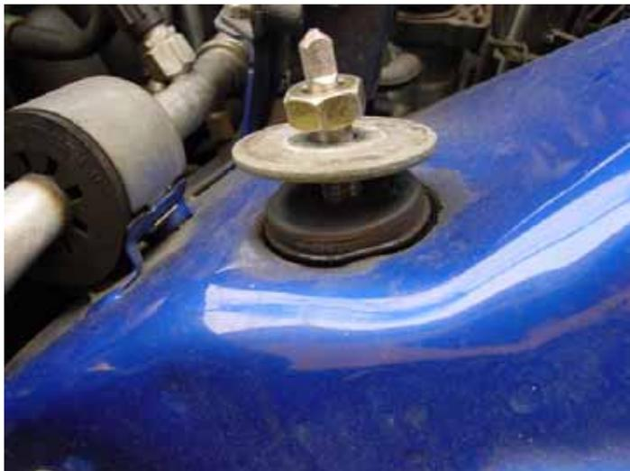
Muttern, U-Scheibe und Gummi entfernen (werden ersetzt)
