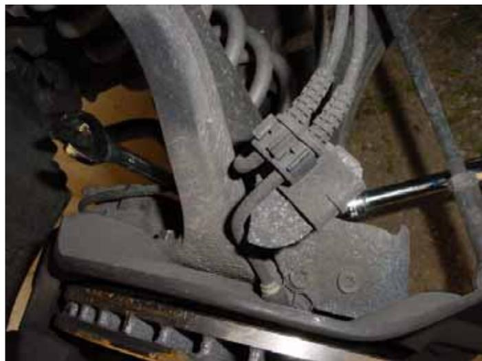
Die Schraube rausdrücken und den Dämpfer entnehmen. Er ist durch das hochbocken ganz einfach zu entnehmen.
