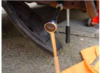
Beim Einsetzten des Dämpfers darauf achten, dass die Kolbenstange sich in der Durchführung im Radlaufs befindet. Das neue Gummi einsetzen.
