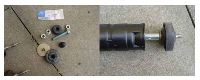
Den Dämpfer einsetzen und mit einer neuen Schraube aus dem Montagekit befestigen. Anzugsdrehmoment 55 Nm
