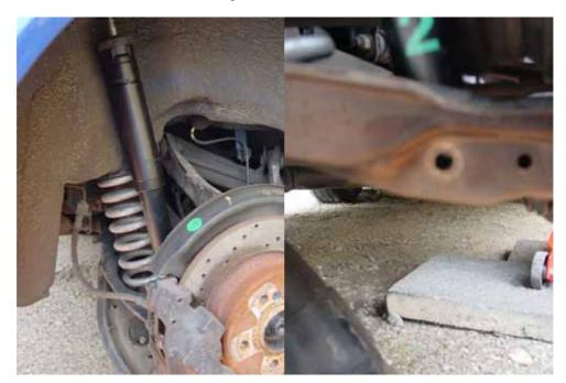
Um den das Loch zur Durchführung der Schraube besser zu zentrieren, einfach mit einem dicken Kreuzschlitzschraubendreher den Dämpfer ausrichten und mit der Schraube fixieren.
