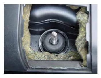
Die neue U-Scheibe auflegen, Muttern aufschrauben (18Nm) und kontern (30Nm).
