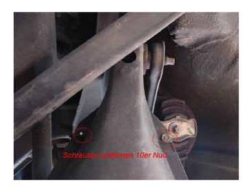
Hiernach kann die Schraube, die den Dämpfer hält mit den Ratschen oder 17er Gabelschlüsseln gelöst und entfernt werden. Danach kann man den Dämpfer entnehmen
