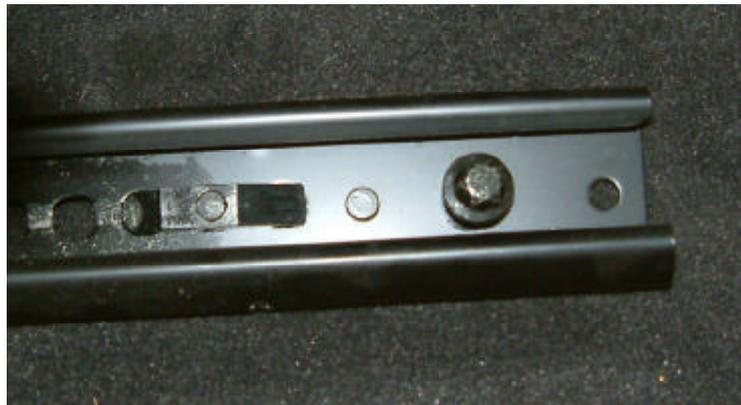
2. Dann den Sitz nach hinten schieben, möglichst die Höhenverstellung auslösen, dann kommt man besser an alles ran. Auch vorne die beiden Schrauben lösen. Dann kann man den Sitz herausnehmen.
