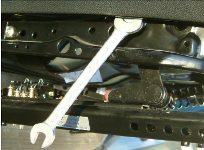
9. Die Bolzen auf beiden Seiten werden gelöst und anschließend in die Löcher weiter vorne wieder eingesetzt. Vorher bitte die Kunststoffeinsätze der Löcher heraushebeln und vorne wieder einsetzen.
