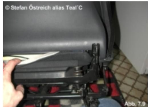
Nun vorsichtig den Stoffteil von vorne herausziehen und Lederbezug mit Schaumstoffmatte, die das Heizelement trägt nach oben klappen. Das Leder sowie die Heiz/Schaumstoffmatte vorsichtig über die Kopfstützeinlässe ziehen. Abb. 7.10
