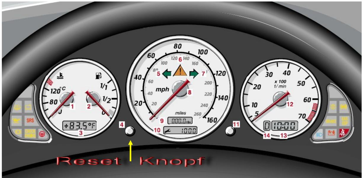
1. Um die Service Intervall Anzeige zurückzusetzen, schalten sie die Zündung ein, (Motor muss ausgeschaltet sein, normale Fahrstellung des Zündschlüssels)
