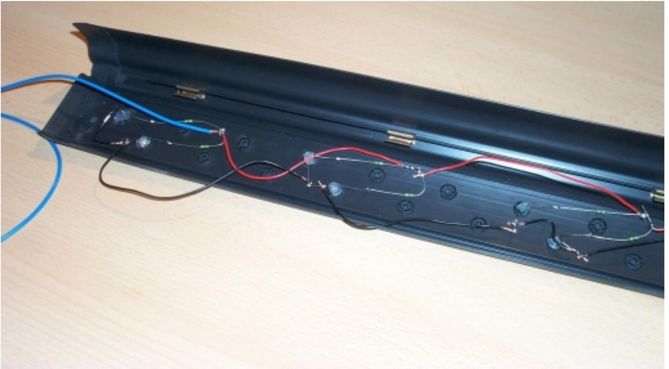
Jetzt habe ich alle Lötstellen noch mit Heißkleber isoliert und die Kabel und Widerstände auch gleichzeitig fixiert.
