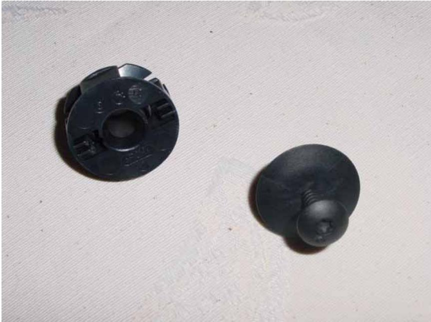
Nieten teilen (linker Teil wird in den Unterboden geclipst mit dem rechten der Schweller befestigt)
