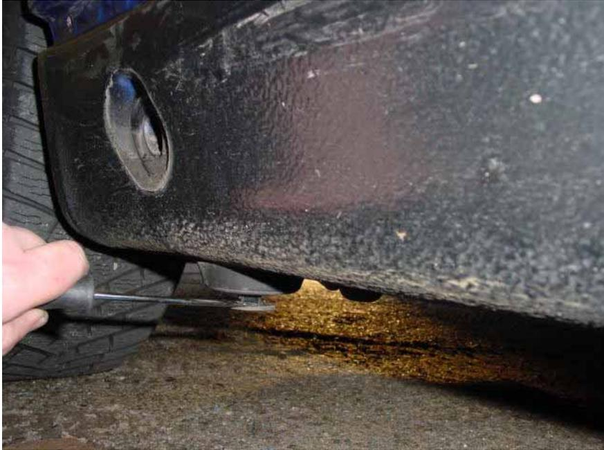
Mit Schraubendreher Zapfen heraushebeln und Stopfen durch wackeln entnehmen
