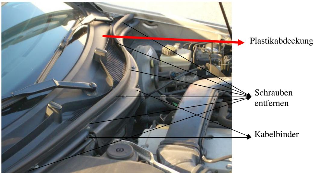
Zusammenbau in umgekehrter Reihenfolge !!
