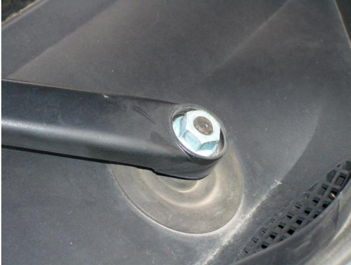
3.) Mutter mit 13 Nuss lösen und bis zur Hälfte abschrauben
