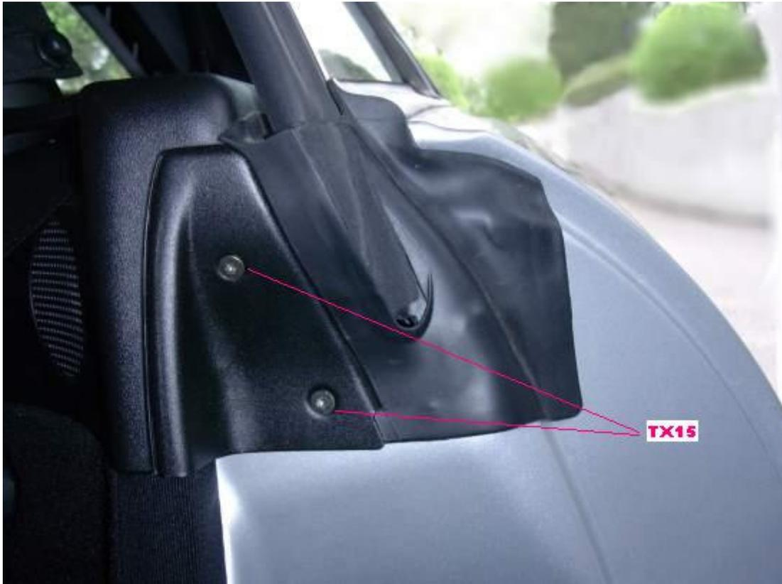
Die beiden Torx-Schrauben entfernen und die Metallabdeckung abnehmen.
