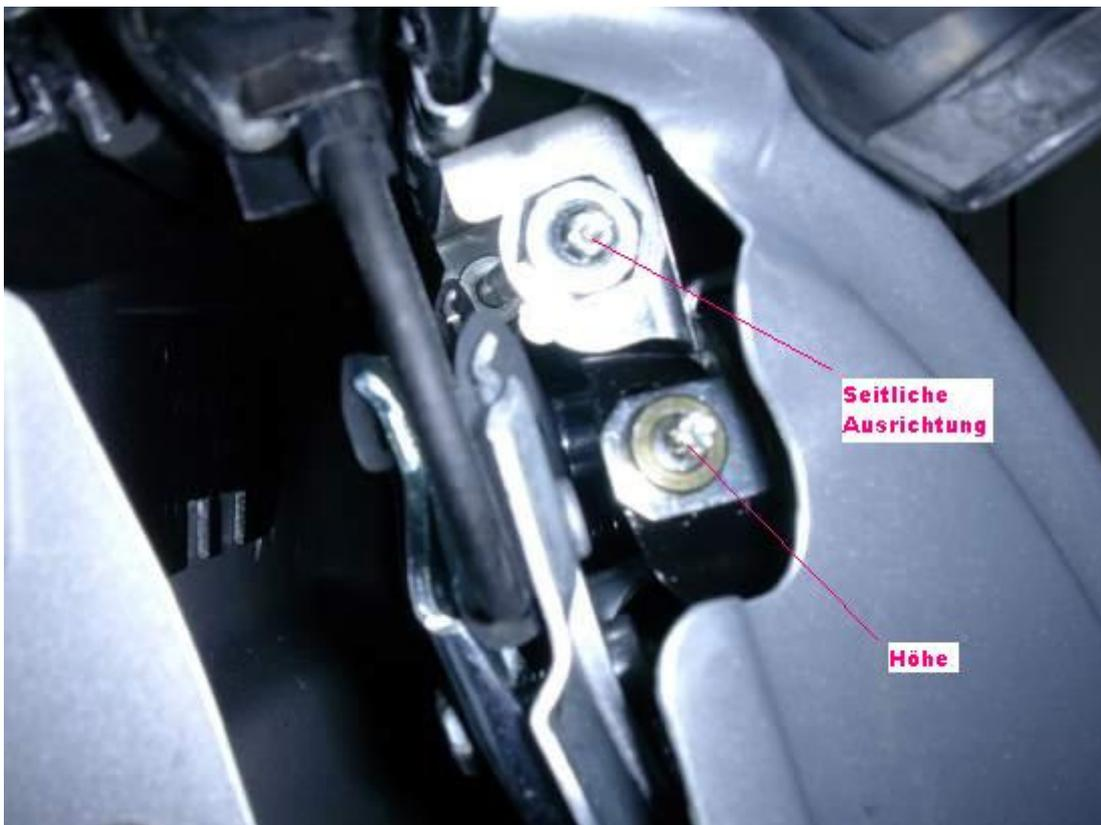
Falls die Neigung der Scheibe nicht passt, befindet sich im hinteren Radkasten eine ovale Gummiabdeckung, hinter der sich eine Einstellmöglichkeit für die Scheibenneigung befindet:
