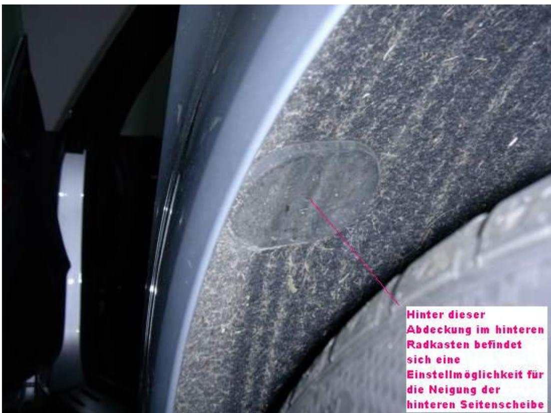
Mit der oberen Schraube für "seitlichen Ausrichtung" kann man die komplette Scheibe nach innen (also so, dass der Abstand zwischen Scheibe und Überrollbügel kleiner wird) oder nach aussen
