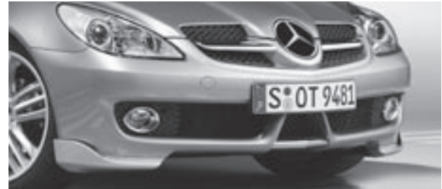
Frontschürzenspoilerlippen, Chromzierteile für Querfinnen im Kühlersteig und Stoßfänger
