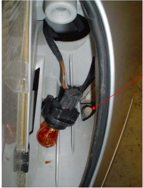
Diese schraube entfernen.
