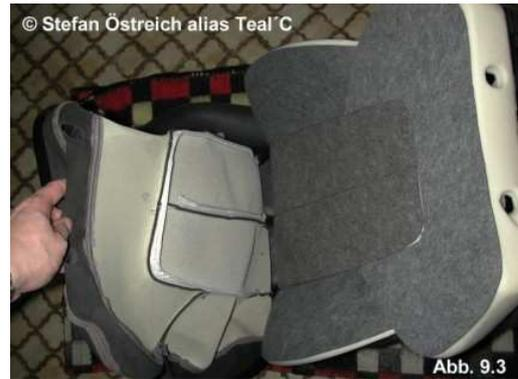
Nun die Metallstangen in jede Klammer eindrücken, am besten von oben nach unten. Die Klammern müssen so sitzen wie in Abb. 9.4
