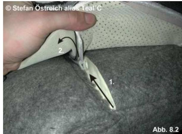
Wie in Abb. 8.2 in Pfeilrichtung 1. einen kleinen Schraubendreher unter die Halbrundung der Plastikklammer stecken und mit der Pfeilbewegung 2. die Klammer aushebeln. Nun die Plastikklammer von hinten aus der Heizmatte ziehen. Wir brauchen Sie für die Neue Matte. Wenn Ihr die Matte vom Lederbezug getrennt habt seid Ihr mit dem Ausbau fertig. Nun kommt der Einbau... ☺ keine Müdigkeit vortäuschen die Hälfte ist geschafft !
