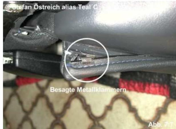
Ist die Plastiklippe rundherum vom Sitz gelöst, müsst ihr auf der Rückseite unterhalb der Plastikverschalung den Stoffteil der Rückenlehne lösen. Auch dieser ist in einer Plastiknute eingeklemmt. Abb. 7.8-7.9
