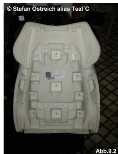
Nun die Metallstäbe in den Stoffhülsen wieder in die Klammern eindrücken, sodass sie sich in die Spalten der Heizmatte einziehen. Dazu die Seitenteile des Lederbezugs umstülpen wie in Abb. 9.3
