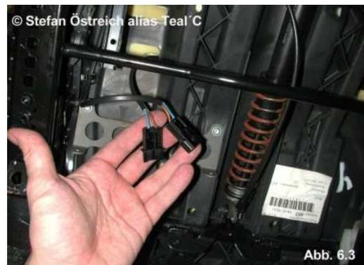
Die Leitung für die Rückenlehne läuft nun an der Unterseite des Sitzes zur Rückenlehne und ist mit 2 Straps-Kabelbindern befestigt. Ihr könnt diese aufmachen, indem Ihr einen kleinen Schraubenzieher in den Verbinderkopf steckt und die Stopperzunge aufdrückt. Abb. 6.4
