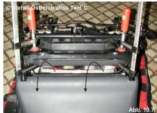
Um die weiße Pappkante mit dem Stoffsaum besser auf Spannung zu ziehen könnt ihr eine Kombizange verwenden. Dann gleich die Kante in die Plastiknute pressen. Mit dem Bordschraubenzieher könnt ihr die Kante nachdrücken Abb. 10.8 - 10.9
