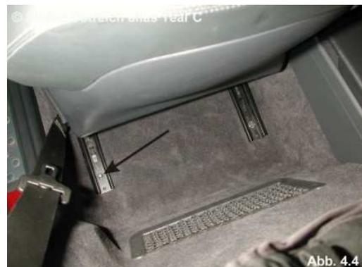
**A C H T U N G !!!** Vorsicht beim herausnehmen des Sitzes. Erst die Kabelverbindung unterhalb des Sitzes lösen. Dies ist die Zuleitung der Sitzheizung. Auch aufpassen beim Herausnehmen, dass ihr nicht mit den Sitzschienen gegen das Plastik bzw. den Lack kommt. Die Schienen sind scharf !!!
