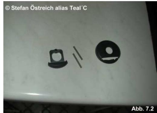
Nun können wir den Bezug anfangen zu lösen. Der Bezug ist sozusagen in die Plastikrückwand „eingesteckt“. Am Rand des Leders ist eine Plastikklippe angenäht, die in eine Plastiknute gedrückt ist. Zusätzlich ist diese Plastikklippe mit Metallklammern, die Widerhaken haben, gesichert. Also vorsichtig ziehen !
