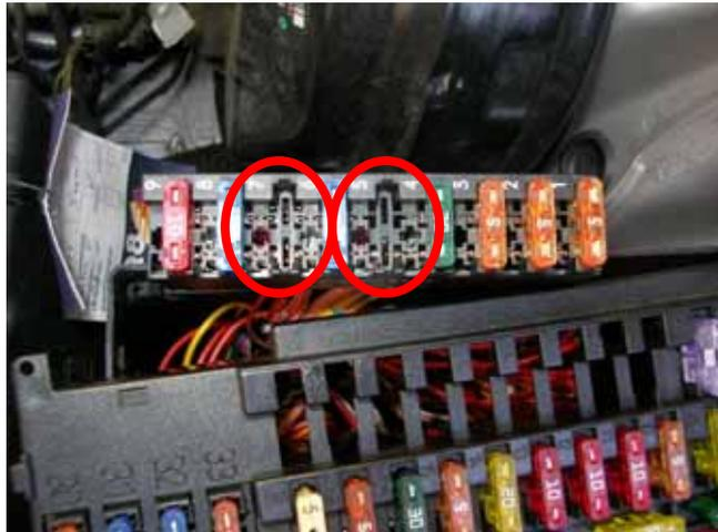
Nun von unten die Verriegelung mit dem Schraubendreher lösen und am besten entnehmen. Die Verriegelung kann einfach mit dem Schraubendreher von hinten her ein bisschen aufgehebelt werden. Die Rasten lösen sich dann. Jetzt kann das gekennzeichnete Kabel B5 aus dem Sicherungshalter 5 entnommen werden (ggf. mit der Zange)
