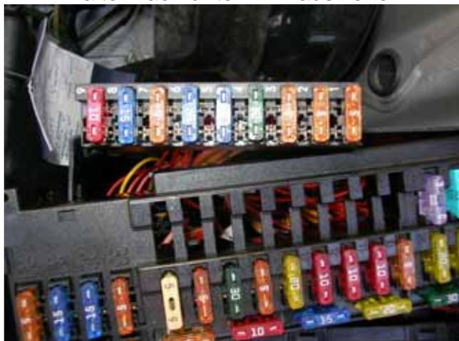
Sicherung 5 (15A) und 7 (5A) entfernen
