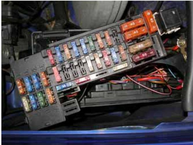
Nun drücken dir den Sicherungsblock A (Sicherung 1-9) aus der Halterung nach unten hin raus
