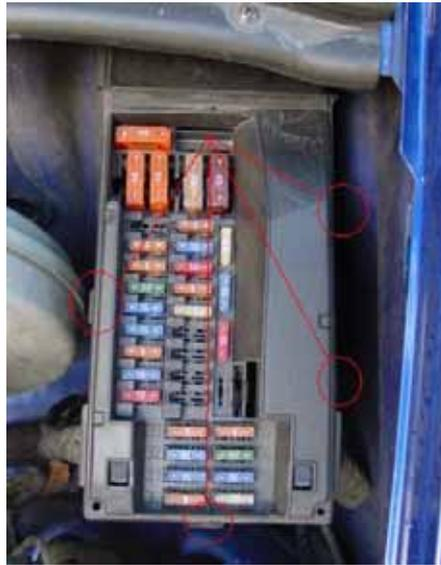
Den Sicherungskasteneinsatz entnehmen. Der ist eingeklipst.
