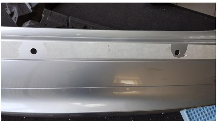
Die Schürze ist elfenbeinfarben und das sieht man in den Löchern von außen, wenn die Sensoren stecken. Also innen abkleben und von innen Farbe in die Lochkanäle sprühen (Kunststoff-Primer und Lack)
