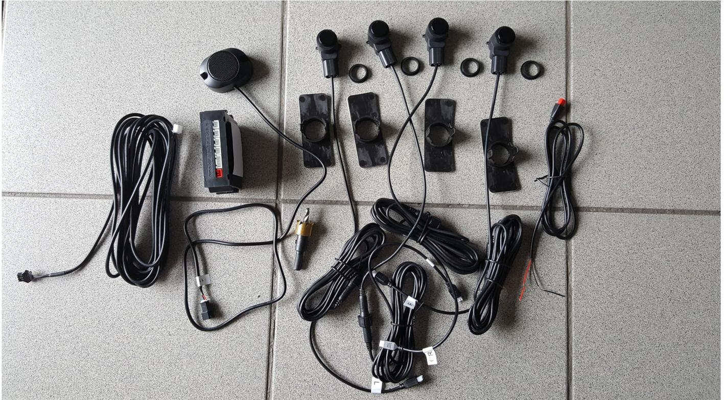
So sieht der Lieferumfang aus + Anleitung. Die Sensoren sind ähnlich den Bosch-Sensoren, allerdings statt dem üblichen Steckanschluss kommt ein 30cm langes Kabel direkt heraus, das über eine weitere Steckverbindung verlängert wird. Man sieht deutlich auch die schwarzen Gummiringe, die im Original farblos sind. Hat man ein schwarzes Auto, passt das sicher, aber rund 75% haben eine andere Farbe. Bei MB sind die ‚Abstandsringe‘ unter der Nummer A 221 542 00 51 gelistet und kosten rund 3€/St.
