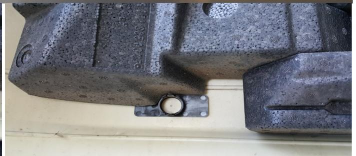
Die Löcher jetzt von hinten mit dem 18mm Bohrkranz vorsichtig bohren (ganz kleine Drehzahl, also fast stehend, und kaum Druck, sofort aufhören wenn man merkt, dass man durch ist und nicht durch den Krepp bohren). Anschließend kann das Kreppband entfernt werden. Den Grad an den Löchern ganz vorsichtig mit Nassschleifpapier  $\geq 1500$  entfernen (nicht außen über die Lackierung schleifen).
