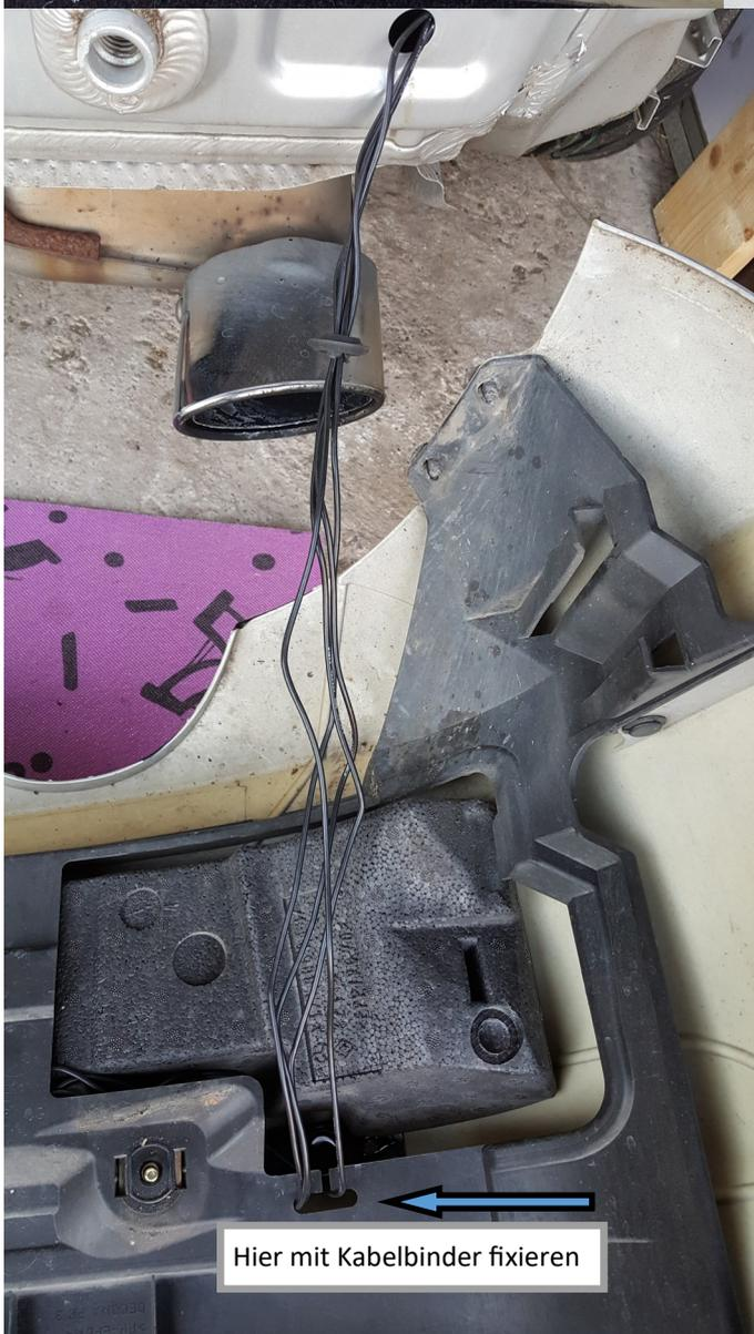
Die Auflageflächen der Halterungen gründlich reinigen, ggf. etwas anschleifen und die Sensoren zusammen mit den Halterungen einpassen, Position kontrollieren und dann ankleben.
