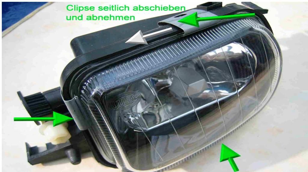
Montage in umgekehrter Reihenfolge. Nach dem Einsetzen des Scheinwerfers ihn wieder befestigen, Kabelstecker aufstecken und **einen neuen Kabelbinder für das vorbeilaufende Kabel anbringen (nicht vergessen)!**
