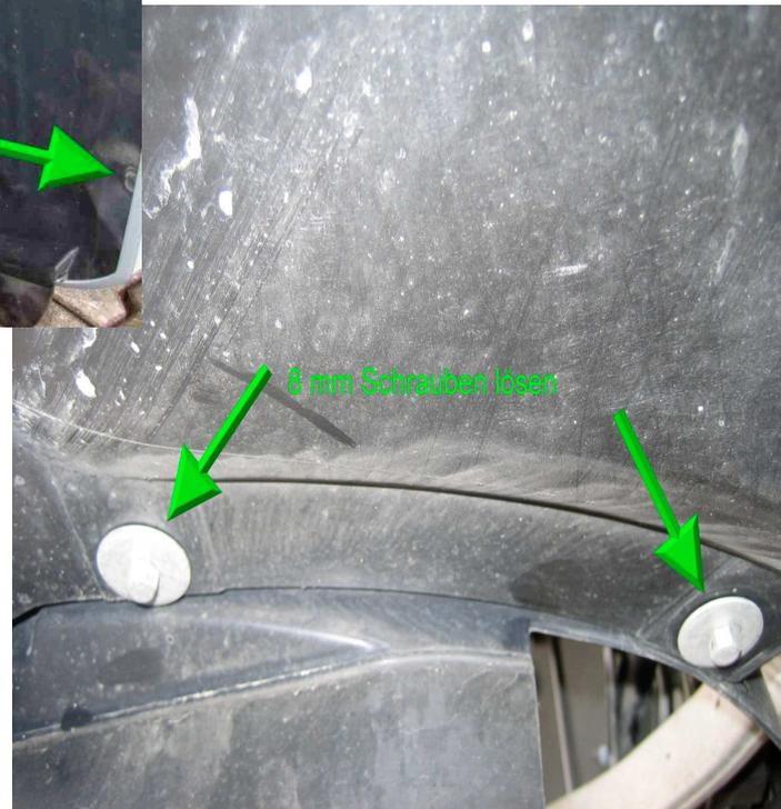
Unter dem Stoßfänger vorne unten zwei Befestigungsschrauben (8mm) abnehmen und die Verkleidung des Radkasten herausnehmen .
