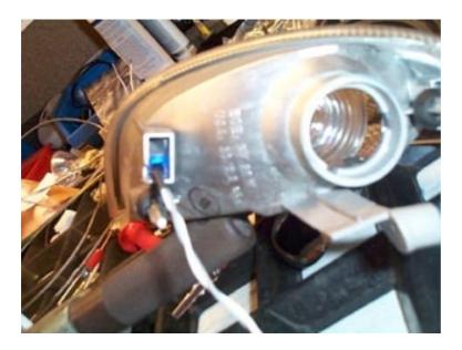
Die Diode 5mm passt perfekt in diese Öffnung man verklebt sie am besten mit der Heißklebepistole es reicht ein kleiner Klebepunkt. Übrigens sollte man die Kontakte der Dioden mit Schrumpfschlauch versehen dieser Isoliert und schützt somit vor Kurzschluss. Am besten man bereitet das schon vor und steckt bzw. verklebt die Dioden ganz zum Schluss.
