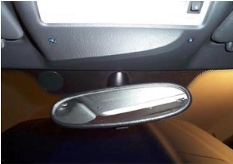
Zum Einbau der 5mm Dioden ( es gibt im Handel auch die passenden kleinen Einbaurahmen dazu 6,5mm) sollte man eine 7mm Bohrung vornehmen, diese passt optimal. Bitte darauf achten das die Dioden nicht herauschauen sie blenden sonst fürchterlich. Ich habe sie weit in den Rahmen geschoben und dann verklebt. Das Licht kommt dann förmlich aus dem Nichts! Ich habe übrigens nach Autofarbe Blau gewählt.
