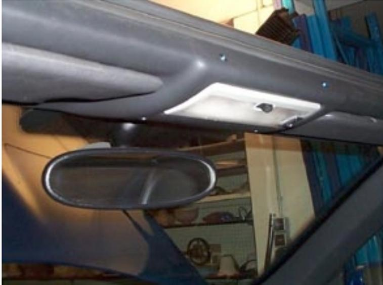
Das Bild zeigt die fertige Konstruktion mit Einbauswitcher in der Leuchte im Hintergrund kann man eine der 4 Leuchtdioden erkennen.
