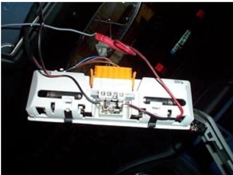
Auf diesem Bild sieht man die eigentliche Verdrahtung, der rechte Kontakt + (rot) bitte bei Dioden auf richtige Polung achten. Die Kontakte der Original-Leuchte lassen sich hervorragend löten. Im + pol sitzt der Schalter.
