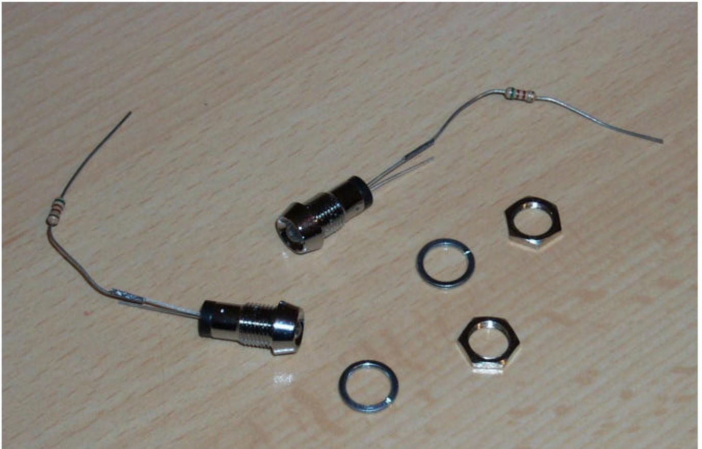
**An die langen Beine der LED wird der Widerstand angelötet.
