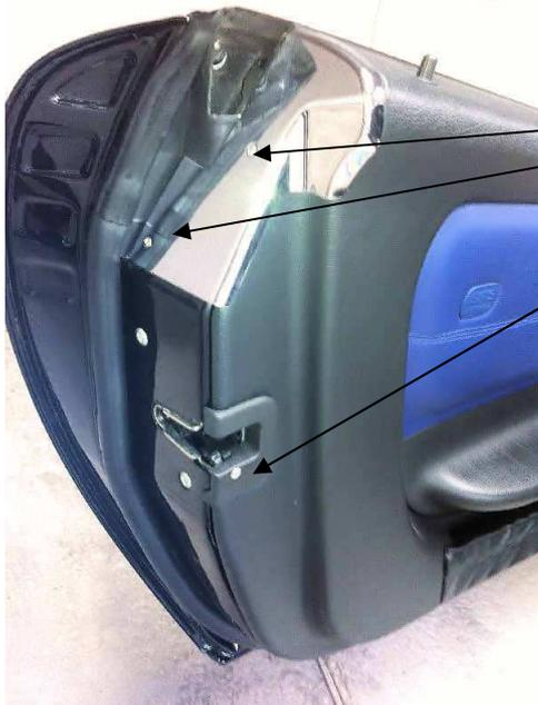
So, fangen wir mit der Demontage der Türverkleidung an. Am Schloß findet Ihr drei Schrauben die entfernt werden müssen:
