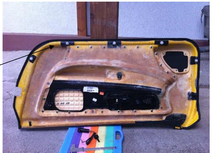
Bohrung 21mm Durchmesser. Mittig und 58mm von der „Kante“.
