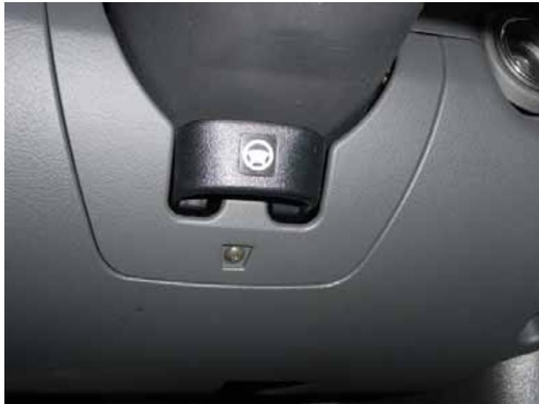
Danach die weiteren Schrauben lösen und entnehmen
