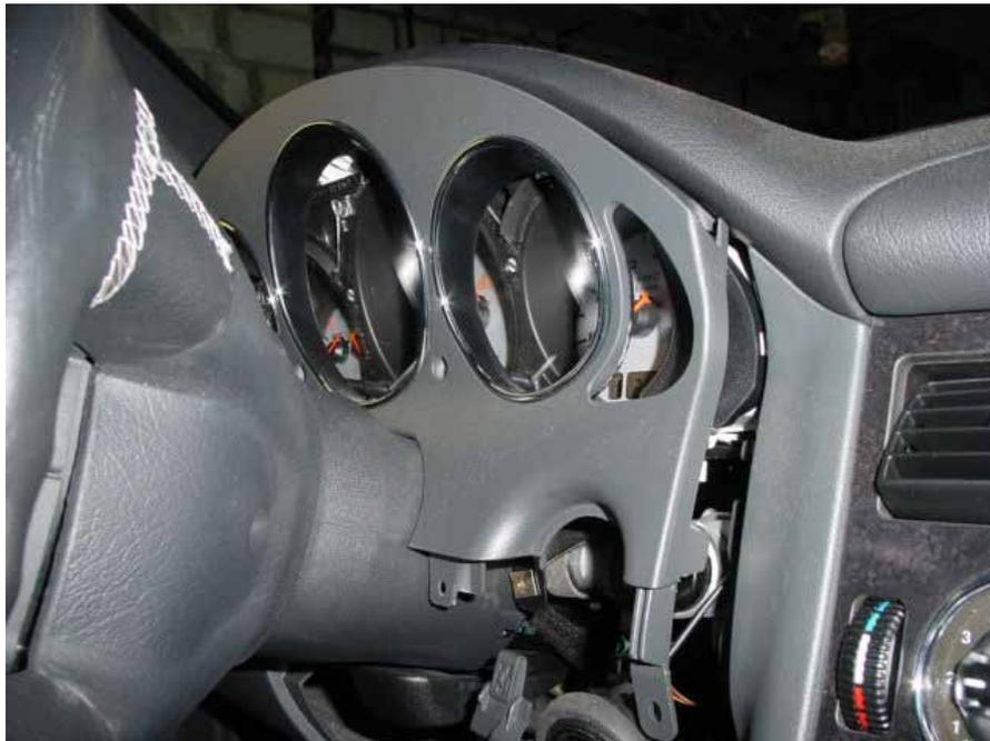
Jetzt die Schrauben am Kombiinstrument lösen
