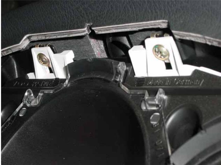
Stecker hinter dem Kombiinstrument trennen und das Kombiinstrument zur Fahrertüre herausnehmen
