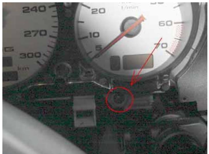
Des weiteren die 2 Schrauben oben am Kombiinstrument
