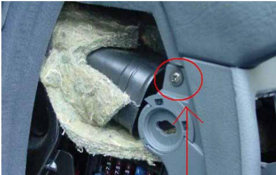
Danach die Schraube in der Linken Luftdusche herauschrauben
