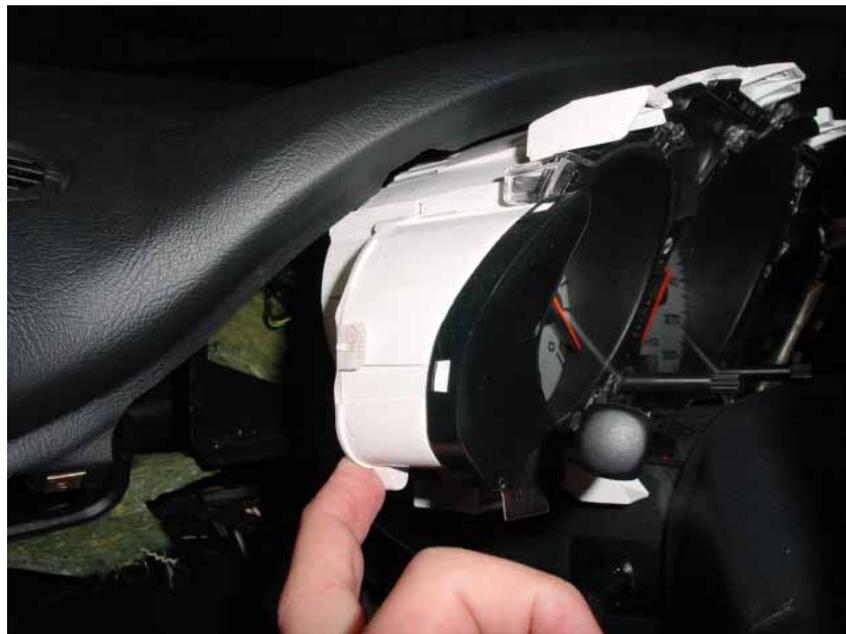
So sieht das Kombiinstrument von hinten aus
