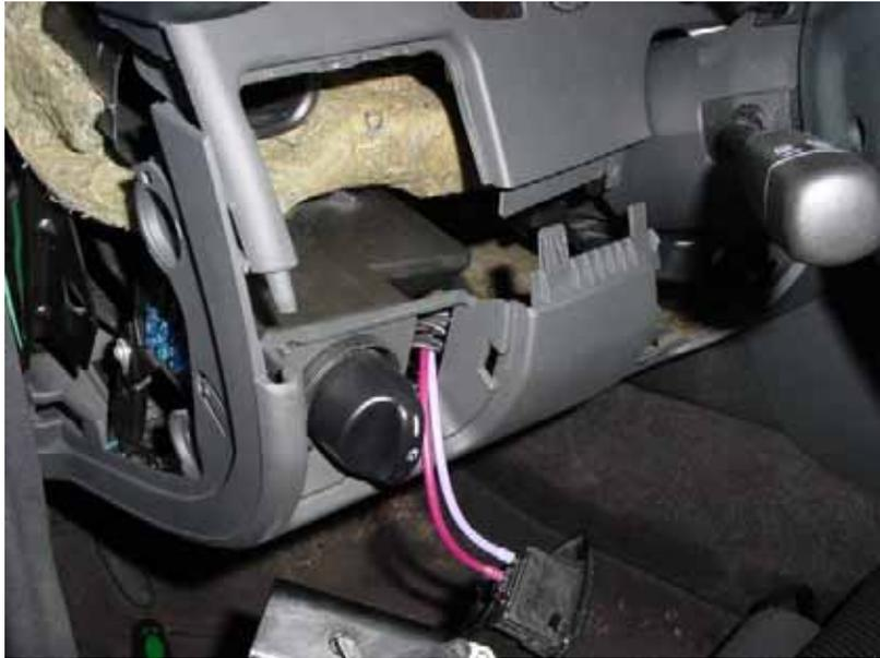
Jetzt folgende Schraube lösen. Vorab den Transponder-Empfänger vom Zündschloss einfach ausklipsen / abziehen
