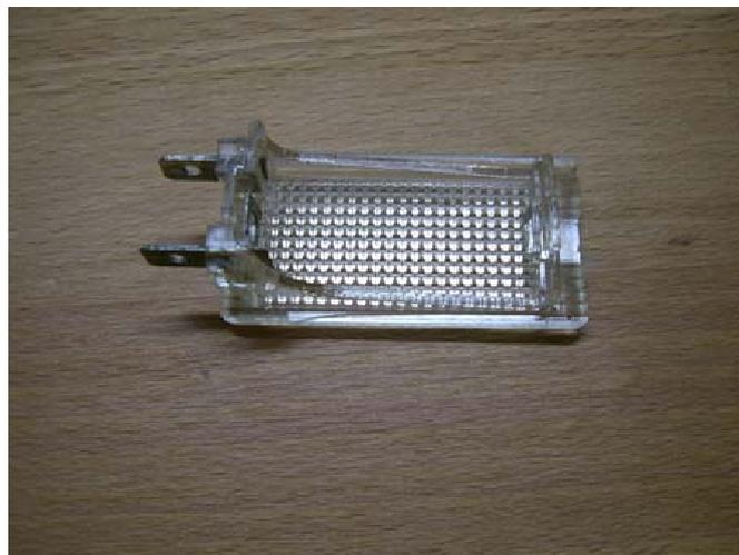
2.) Im nächsten Schritt muß die LED-Zeile gebaut werden. Hier habe ich 3 Reihen mit je 5 LED's auf eine vorher zurechtgeschnittenen Rasterplatine verlötet. Um einen Defekt von Spannungsspitzen vorzubeugen hat jede LED einen eigenen 680 Ohm Vorwiderstand. Diese Platine habe ich dann in den Lampenträger eingesetzt und mit den beiden Anschlüssen verlötet.
