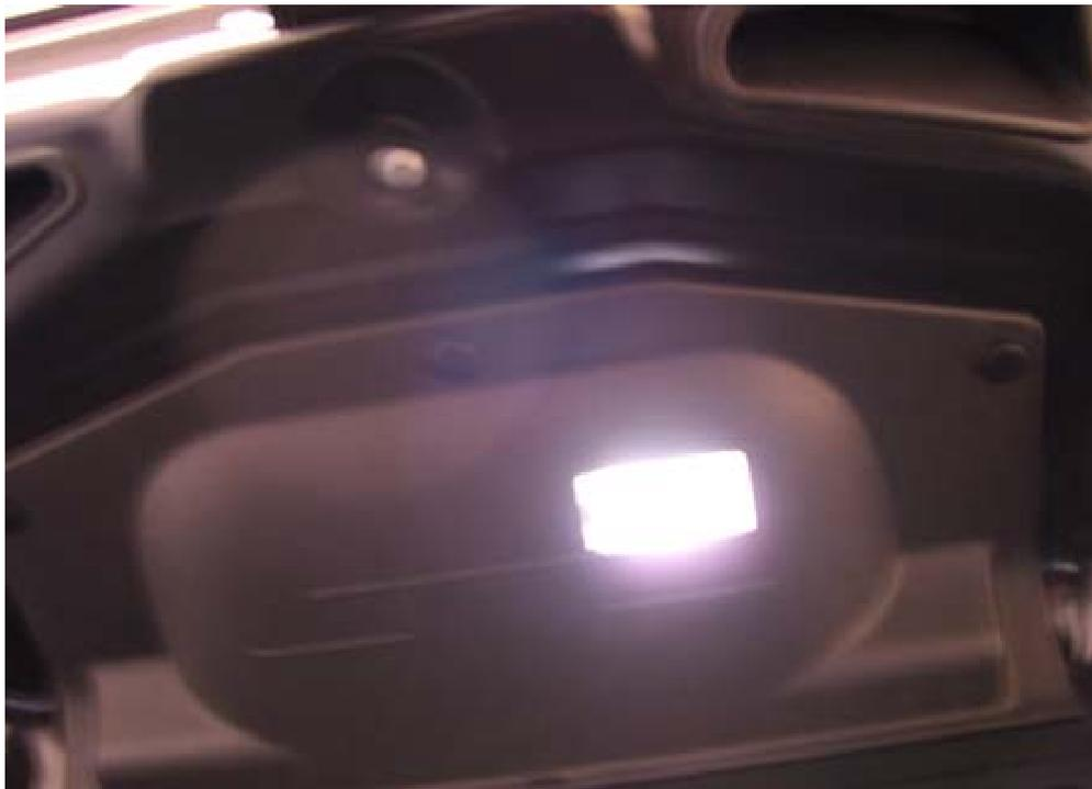
Da ich keine zusätzlichen Kabel durch die Kofferraummechanik verlegen wollte, habe ich die benötigten Anschlüsse direkt im Kofferraumdeckel abgenommen. Um die "Lampen-defekt" Anzeige im Armaturenbrett auszutricksen funktioniert die Schaltung nur mit den LED's. Eine handelsübliche Soffittenlampe mit 10W würde diese Anzeige zum leuchten bringen und auch zu viel Abwärme am Schlauch der Zentralverriegelung entwickeln
