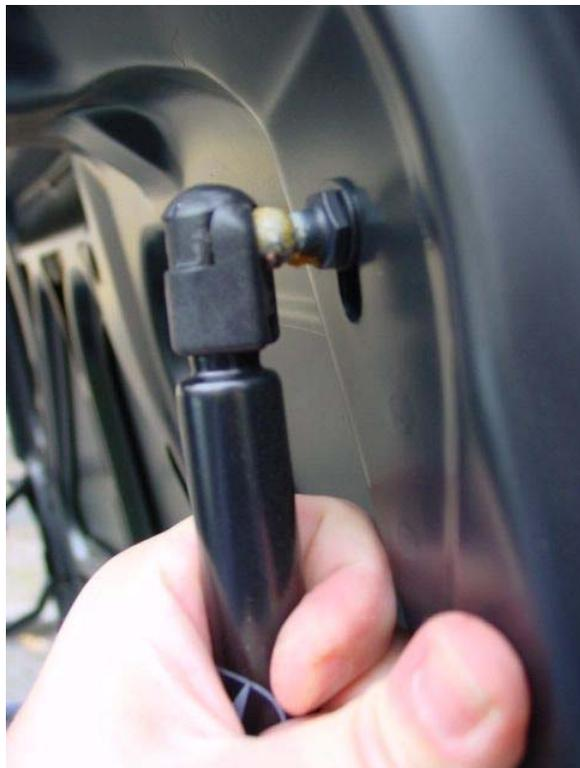
Den unteren Clips auch entfernen und Dämpfer abziehen
