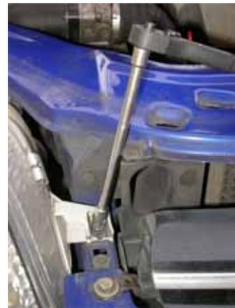
Nun den Stecker am Scheinwerfer entnehmen und den Verbindungsstecker vom Kabelbaum lösen, sowie die Leuchtweitenregulierung.
