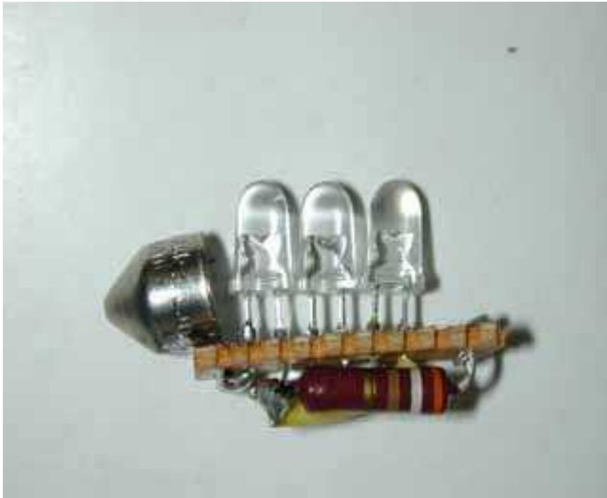
Damit im Armaturenbrett keine Warnung angezeigt wird, dass eine Leuchteinheit des Fahrzeuges defekt ist, wird zwischen die beiden Metallkappen ein 68 Ohm Widerstand parallel zu den LEDs und dem Vorwiderstand eingelötet.
