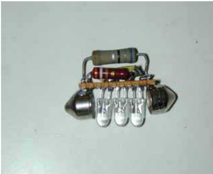
Beim Einsetzen der „Lampe“ muss auf die richtige Polung geachtet werden, damit die Dioden auch funktionieren. Wenn nicht, dann einfach die Platine umdrehen.
