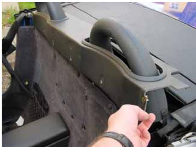
Evtl. muss beim Facelift (Mopf) die kleinen Druckknopfaufnahmen entfernt werden...
