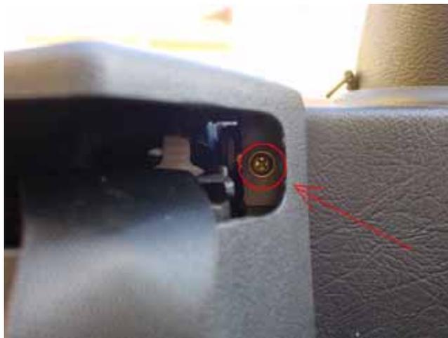
Hier befindet sich ein Schraube (8er Maulschlüssel)
