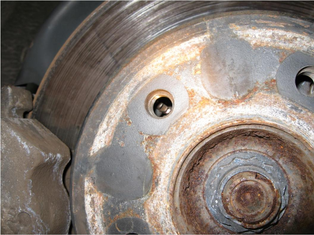
Das Zahnrad kann mit einem Schraubenzieher „Rauf“ gedreht werden, bis sich die Bremsscheibe nicht mehr drehen lässt.
