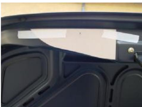
Dann mit dem Akkuschauber ein 5er Loch gebohrt und mit etwas Farbe das Bohrloch geschützt.
