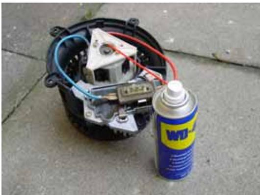
Ggf. nun die defekten Teile tauschen und den Motor wieder in umgekehrter Reihenfolge montieren.
