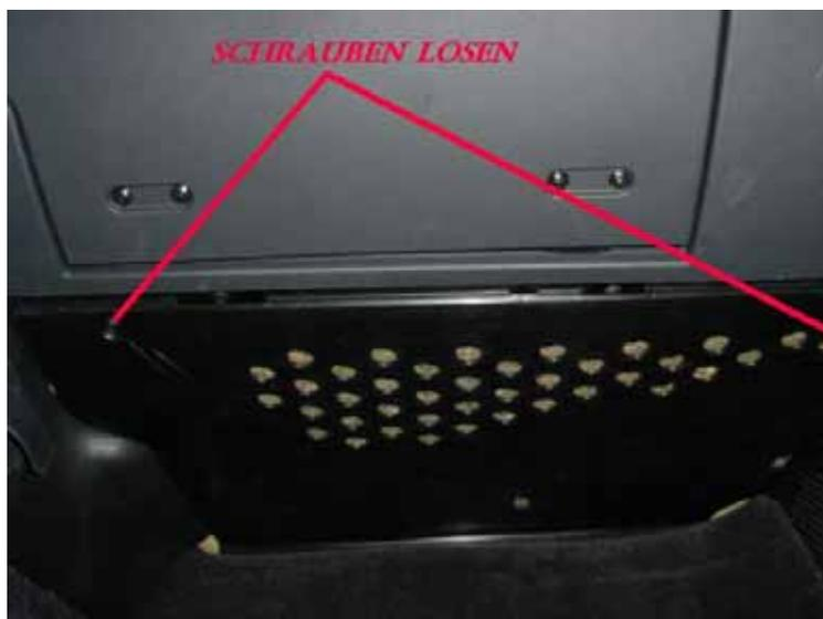
Nun sieht man auf der rechten Seite eine Box. Dort befindet sich der Gebläsemotor drin. Als erstes die elektrische Verbindung trennen.
