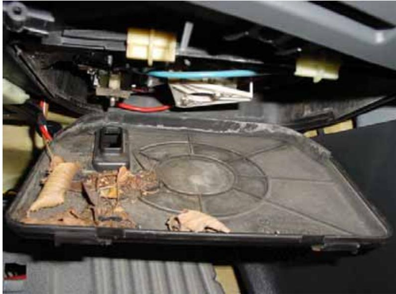
Jetzt sind wir schon am Motor angelangt. Um ihn zu entnehmen die 4 Torx-Schrauben lösen.
