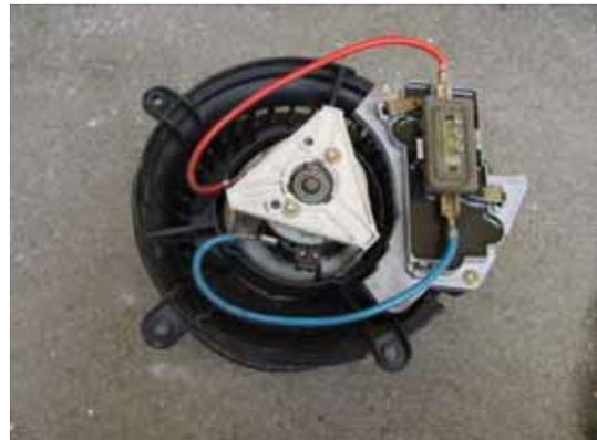
Die Welle kann natürlich auch im eingebauten Zustand geölt werden. Hier am ausgebauten Motor gezeigt.
