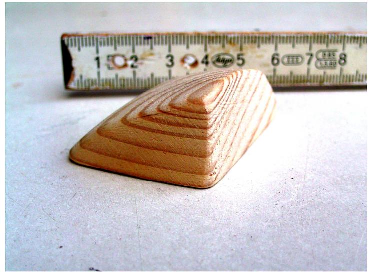
Mit dem Dremel (mit Schleifaufsatz) und/oder von Hand (erst mit 40er, dann 80er, dann 120 - 180er Schleifpapier) das Teil zuschleifen, damit eine schöne „glatte“ Rundung entsteht. Die genaue Form ist sekundär; wichtig ist nur ein fließender Anstieg und eine glatte und sanft gerundete Oberfläche (siehe Bilder oben).
