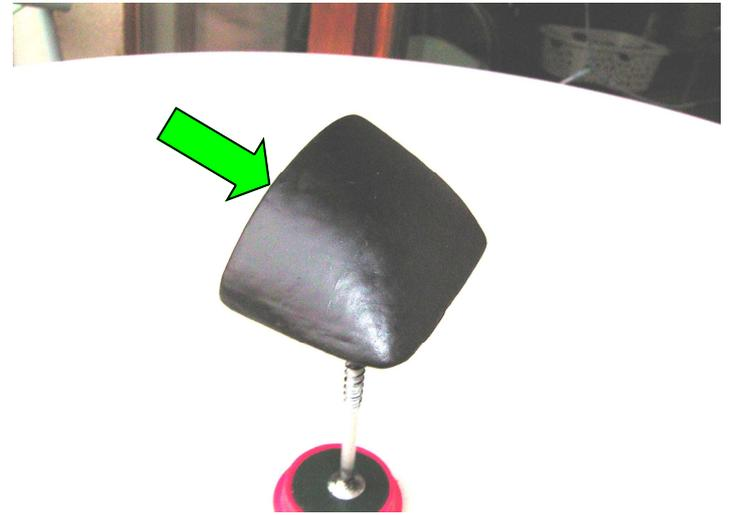
Das fertige Teil seidenmatt lackieren (2 - 3 Schichten, bis die Holzstruktur nicht mehr sichtbar ist) und ggf. auf der Seite, die später dem Fahrersitz zugewendet ist (grüne Pfeile), mattieren oder mit beflockter Selbstklebefolie (Baumarkt) bekleben, damit das Teil später bei Lichteinfall von hinten (also aus Richtung Fahrzeugheck) nicht durch Reflektionen unangenehm auffällt.
