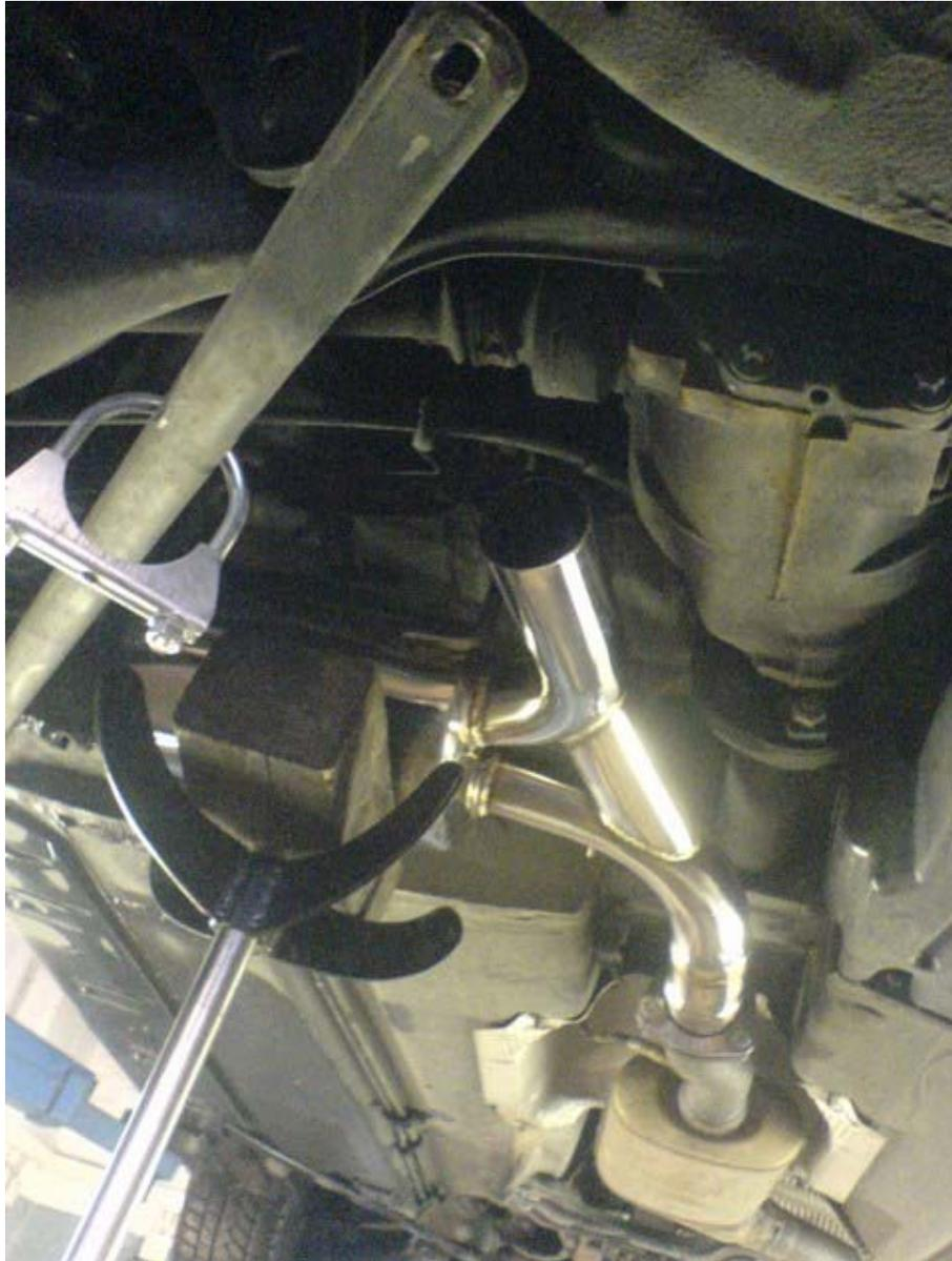
Die gelöste Strebe und der Mittelschalldämpfer.
