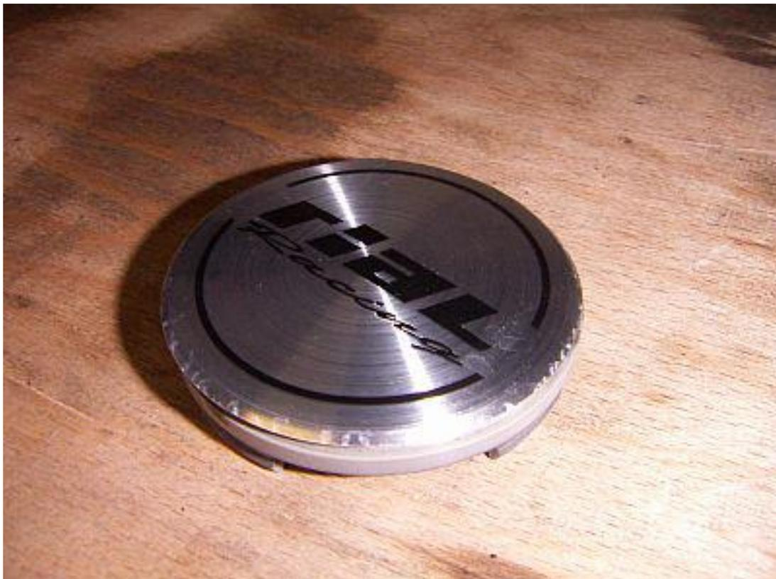
Hier dann das Metallteil vom Plastikträger abmontiert. Gut zu sehen, die gewölbte Oberfläche, die eine Montage eines anderen Emblems erschwert / unmöglich macht .... Ähnliches haben viele Nachrüstfelgen ...
