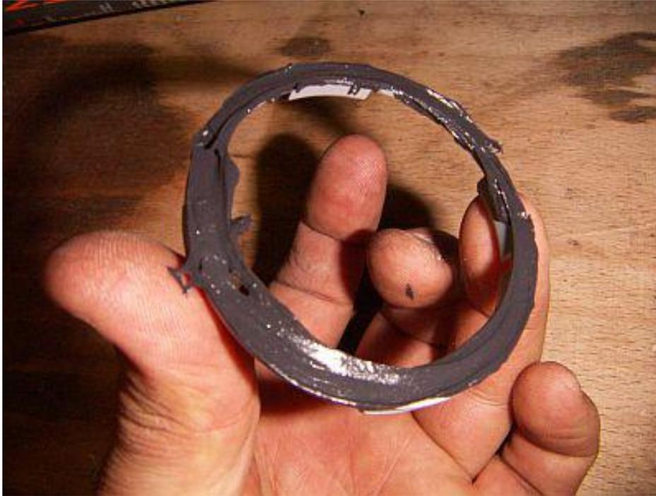
Das Emblem gut andrücken (nicht pressen) und überschüssiges Material außen wegwischen. Innen den Kleber etwas verteilen. Dabei den ring unbedingt zentriert aufsetzen, das der Trägerring einen Tick größer ist. Der Kleber lässt ein Verschieben eine Weile lang zu - danach sollte das Werk waagrecht gelagert werden. Min. 24 Stunden ruhen lassen !
