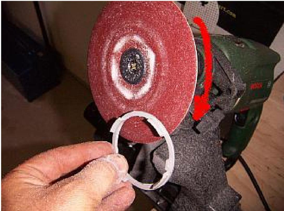
Danach egalisiert man noch kleinere Unebenheiten mit einem plan auf dem Tisch liegendem Schleifpapier. Alternativ lässt sich auch ein Schwingschleifer verwenden, dabei hat man jedoch nicht das nötige Feingefühl punktuell Material wegzunehmen. Ich habe die Ringe auf ca. 2mm runter geschliffen - Sind immer noch stabil genug. zumal auf denen keinerlei Belastung ist, kann da nix brechen.
