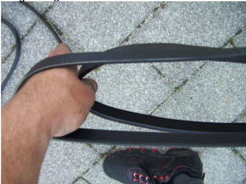
Fertig montiert sieht das dann so aus ... Ich hatte das Ganze aus Vorsicht erstmal ohne den zweiten Riemen montiert um zu sehen ob genug Platz ist. Warum sieht man im nächsten Bild. Definitiv sollte man den zweiten Riemen aus Platzgründen vorher montieren -- ansonsten muss man den zwischen Riemen Spanner neben dem Kompressor und größerer Scheibe durchwürgen ... etwas den Spanner drehen half dabei.
