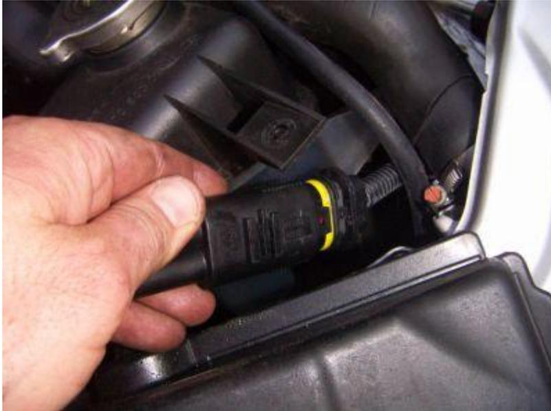
So sollte das aussehen was man ausbaut. Deutlich zu sehen, die seitliche Halterung, wo der Stecker im eingebauten Zustand eingeschoben wird damit nix rumbaumelt ..
