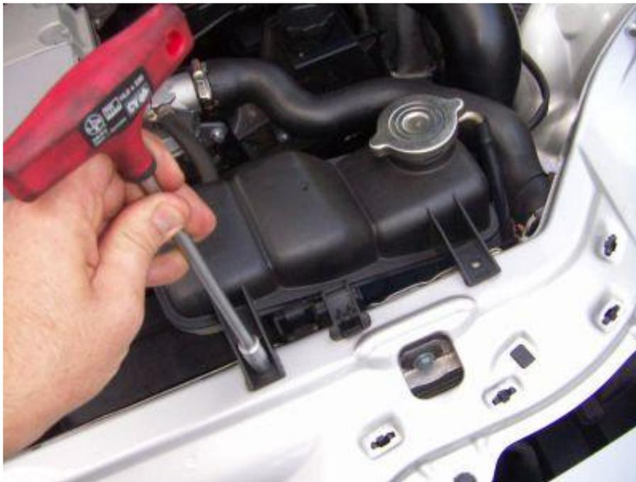
Nun den Kühlerventilator raus, dazu die beiden Klammern oben abhebeln, die die Verkleidung halten. Unten ist die nur eingesteckt. Dazu aber vorher die elektrischen Verbindungen zum Ventilator und Ausgleichsbehälter lösen ... Die Stecker kann man später nur in einer Position zusammenstecken, also keine Angst davor...
