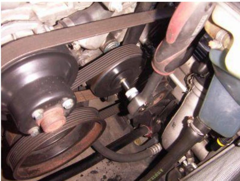
Wenn man die Riemen eh grad runter hat kann man zweckmäßigerweise die Wasserpumpe kontrollieren. Tritt Flüssigkeit aus ? rattert die beim Drehen mit der Hand ? Ist Spiel in der Riemenscheibe vorhanden ?
