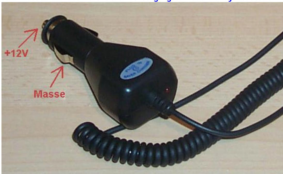
Nachdem ich die Kontakte des KFZ-Laders mit rauhem Schmirgelpapier angeschliffen habe, konnte ich jeweils ein Kabel an die Kontakte anlöten. Bei einigen Ladern muß man beide Massepunkte miteinander verbinden. Danach mit Isolierband gut umwickeln, um einen Kurzschluss zu vermeiden.
