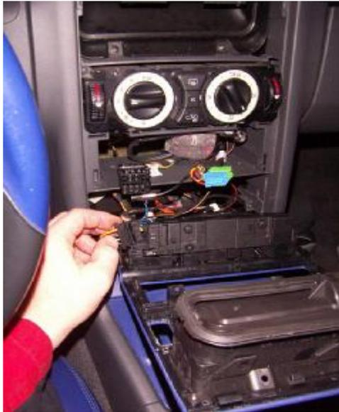
...dahinter liegende Stecker der unteren Schalterleiste vorsichtig lösen.
