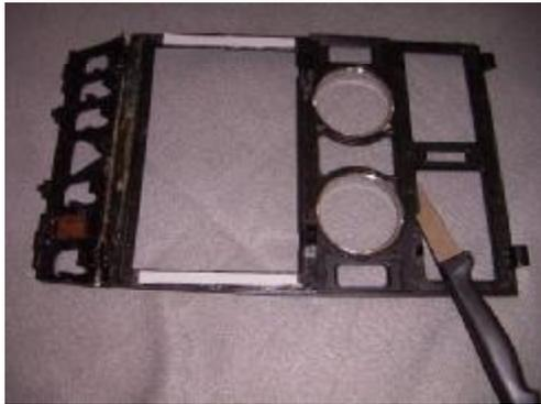
Der Ausbau der Chromzierringe ist recht trickreich. Dies am besten am Abfallstück des anderen Blendenteils üben... Hierbei mit einem Messer zwischen bei beiden verklebten Teile der Blende dreinfahren und diese vorsichtig "aufbrechen" Hier gut zu sehen die Verstärkungen der Blende an den Schnittstellen ...
