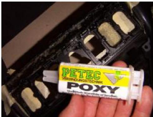
Bei meiner Blende musste ich eine Schalteröffnung verschliessen. Kleband drauf und von hinten Epoxy reingefüllt egalisierte diese Öffnung vollends...
