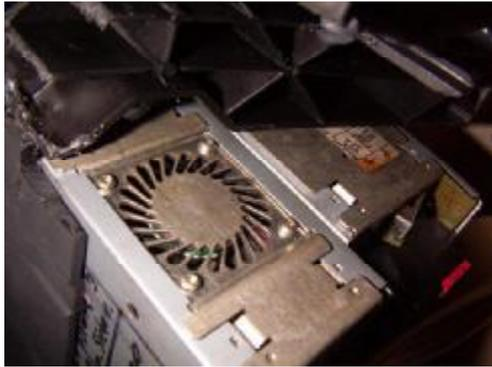
**UNBEDINGT die Lüftung freilassen. Dazu die Halterung an dieser Stelle aussägen !!!!**
