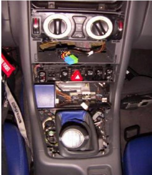
.. Den Aschenbecher und Ablagefach ausbauen. Dazu die Schrauben unterhalb lösen. Siehe Bild.
