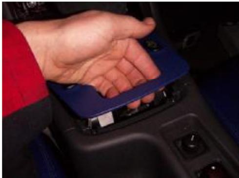
.. Die Verkleidung ist geclipst. Etwas anheben und dann vorsichtig die Stecker der Fensterheberschalter und der Airbagwarnleuchte ausstecken.
