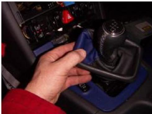
... Schalthebel ausbauen. Dazu den Ledersack ausklipsen um die darunter liegende Verkleidung lösen zu können.
