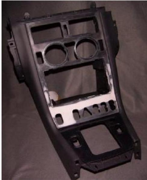
... spachteln der Übergänge der Blende mit handelsüblichem Spachtel. Satt auftragen, da wird eh das Meiste wieder abgeschliffen. Zudem feilte ich die Schalteröffnungen etwas mit einer kleinen Feile um den Betrag des zu erwartenden Überzugsmaterials - des Leders - etwas auf. Sonst klemmen die Schalter wenn überzogen ist !!! Die Komplette Blende schliff ich dann mit feinem 400er Schleifpapier an um eine glatte Oberfläche zu bekommen und den nächsten Schritt vorzubereiten.
