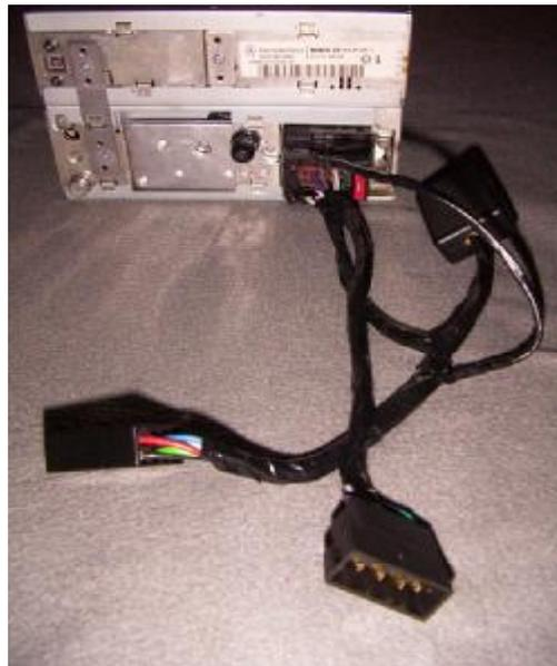
Can-Bus-Adapter und Lautsprecherkabeladapter. Solche Kabel gibt's z-B. bei Conrad oder im Auto-HiFi-Laden zum selbst konfektionieren. Ich baute mir damit einen kompletten Adapterstecker für das Bordnetz des SLK, da ich nix von Kabel abwickeln und gar verlöten halte. Stets muss das Ganze zurückrüstbar sein.
