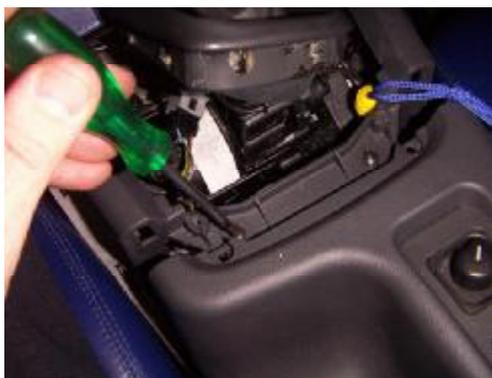
.. Die Schrauben der Mittelkonsole vorne und im Ablagefach unter der Teppicheinlage lösen und diese ausbauen. Leitungen vor dem entnehmen abstecken. Es geht mit etwas Gefriemel auch ohne Komplettausbau, jedoch ist es so weitaus bequemer, vor allem wenn noch ein Kabel zum CD-Wechsler installiert werden soll, was dann ratsam ist.
