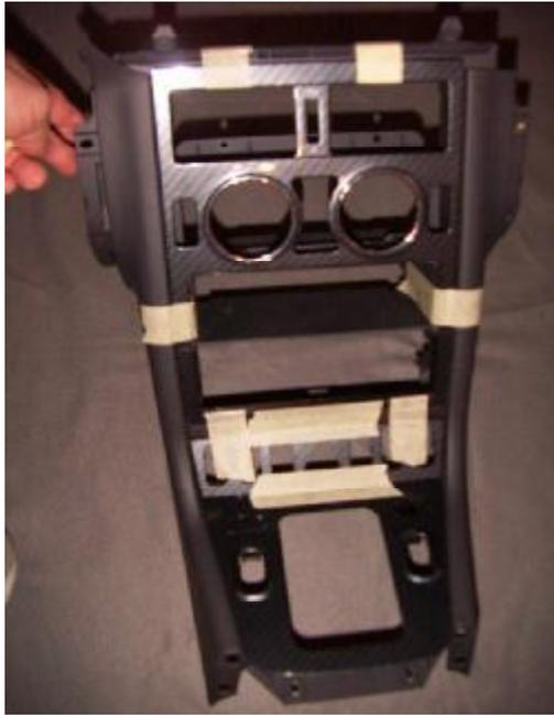
Erstes zurechtfeilen im unteren Bereich, einpassen und fixieren mit Klebeband an der Mittelkonsole. Beide später mit Plastik- oder Metallverstärkungen im Bereich der Schnittstelle zusammenkleben
