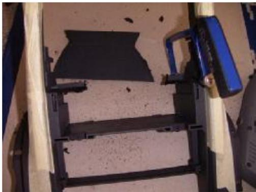
...Nun die DIN-Halterung der Mittelkonsole im oberen Bereich entsprechend zurechtstutzen. Dabei immer langsam vorgehen und lieber 3x schneiden als einmal zuviel. Zwischendrin immer wieder das Gerät einschieben und die Blende drauf halten.
