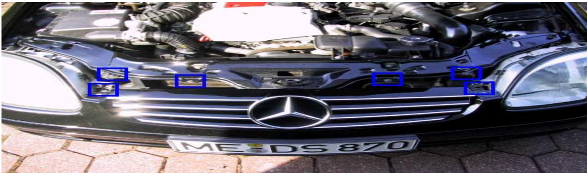
An der Unterseite kann der Grill durch Gegenklopfen mit der Hand von Außen gelöst werden. Keine Panik, der Grill hängt etwas fest, aber stetes Klopfen löst den Grill. Dann einfach herausnehmen.
