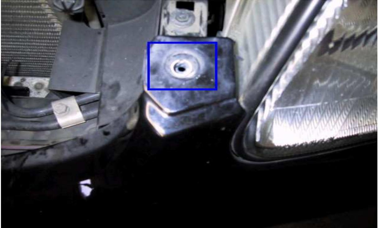
Dann den Grill mit dem Halter zuerst rechts und dann links einhaken. Das folgende Bild beschreibt die Position, wo der Halter 'eingeklemmt' wird.
