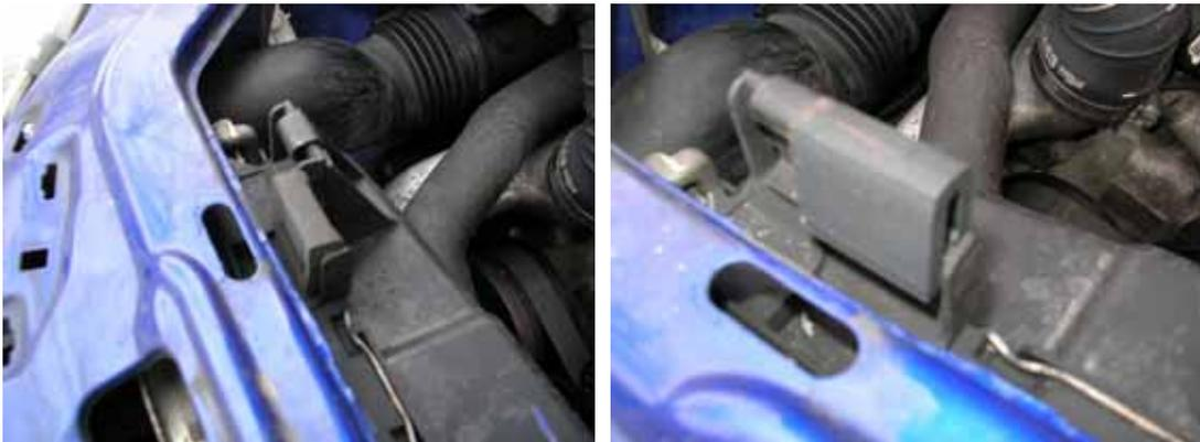
Dann die Sicherung einsetzen
