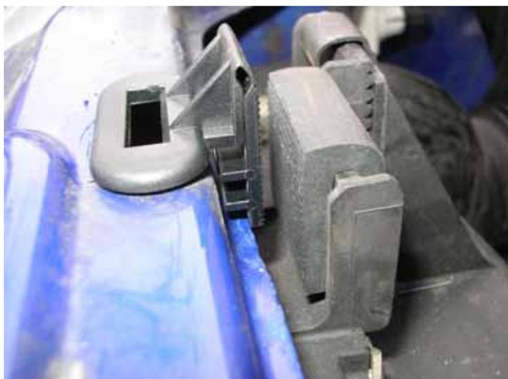
Abschließend den Bügel einsetzen
