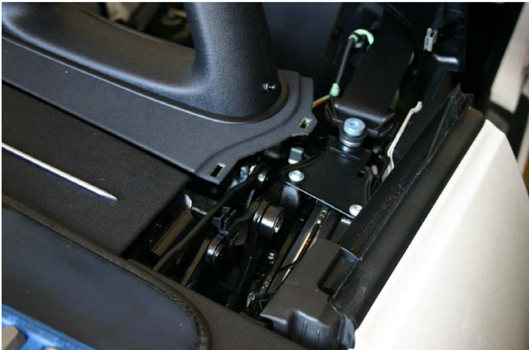
**6) Abdeckung um die Überrollbügel anheben, aus der Verankerung lösen und entfernen**
