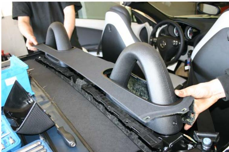
7) Rückwand des Fahrzeuginnenraums Kunststoffschrauben lösen und Teppich nach vorn klappen
