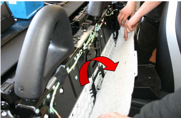
**8) Alle Schrauben der schwarzen Metallrückwand lösen (45 Torx)**
