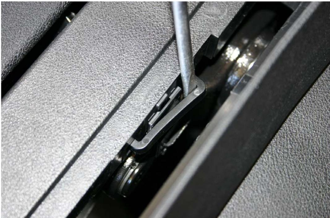
5) Abdeckung oberhalb des Gurtausgangs komplett anheben und nach vorn ziehen
