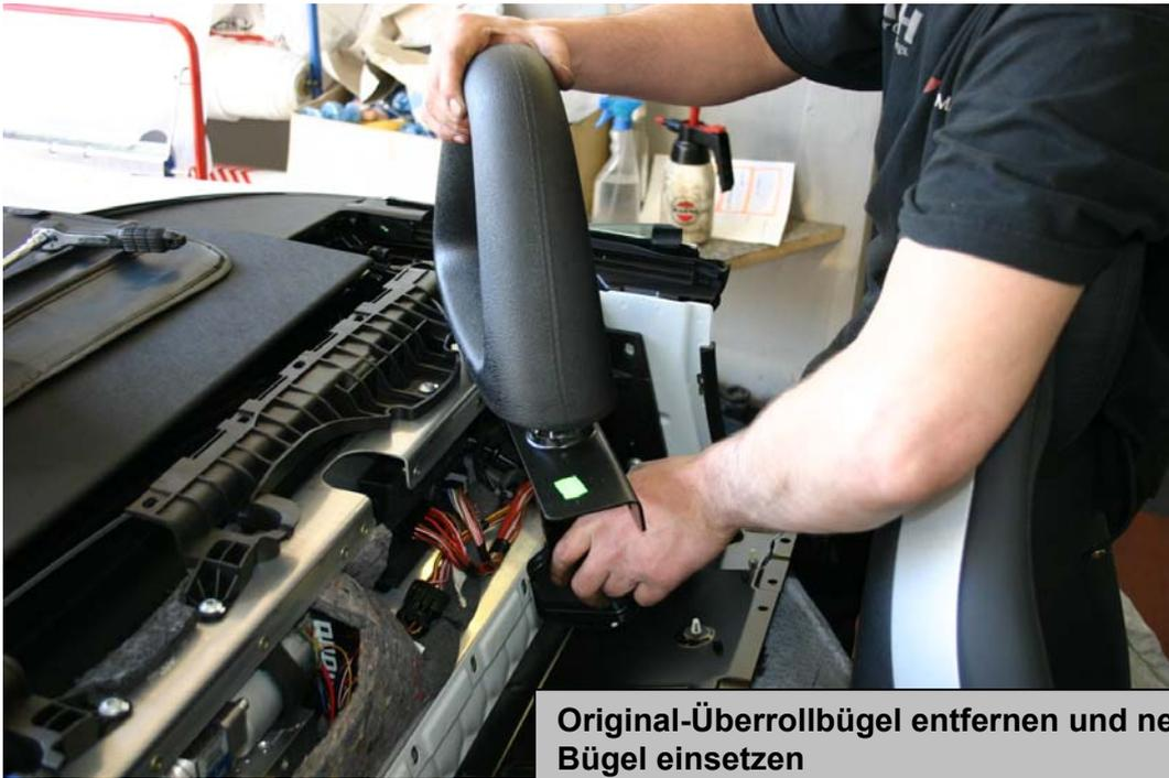
**Original-Überrollbügel entfernen und neue Bügel einsetzen**
