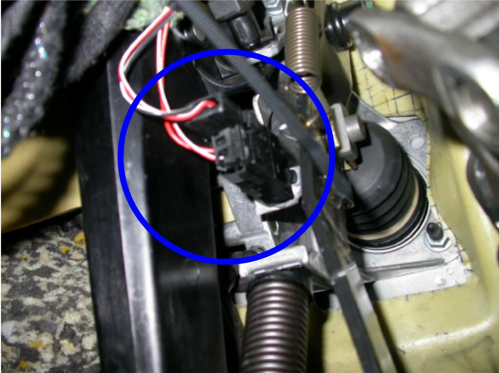
Der Schalter sollte sich nach einer Drehbewegung herausziehen lassen. Danach nur noch die Kabel abziehen und den Schalter wechseln. Wenn das alles geklappt hat, alles wieder zusammenbauen und keine Schraube über behalten.
