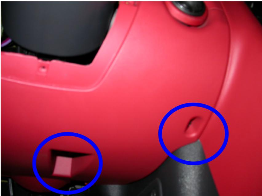
Die beiden „Schrauben“ bekommt man entweder mit einem breiten Schlitzschraubenzieher oder mit einem Geldstück auf:
