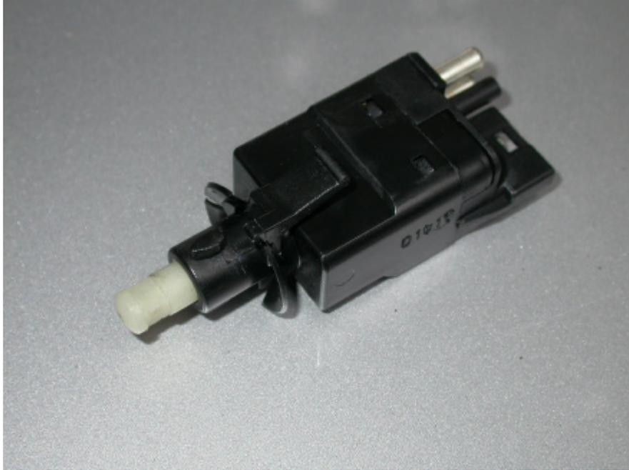
Der Bremslichtschalter sitzt oberhalb des Bremspedals. Für den Wechsel muss man zuerst die Verkleidung im Fahrerfußraum abschrauben:
