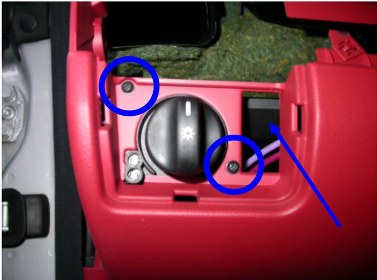
Der Pfeil in dem obigen Bild markiert die Stelle, an der das Drehrad für die Weitenregulierung der Scheinwerfer sitzt.
