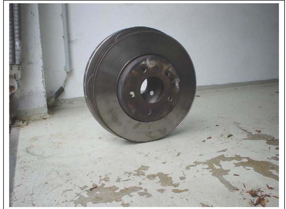
**Achtung !** Lt. Ate soll die neue Bremsscheibe nicht gereinigt werden (z.B. mit Bremsenreiniger) da dies den Korrosionsschutz zerstören kann. Die Bremsscheibe ist bereits gebrauchsfertig im Karton.
