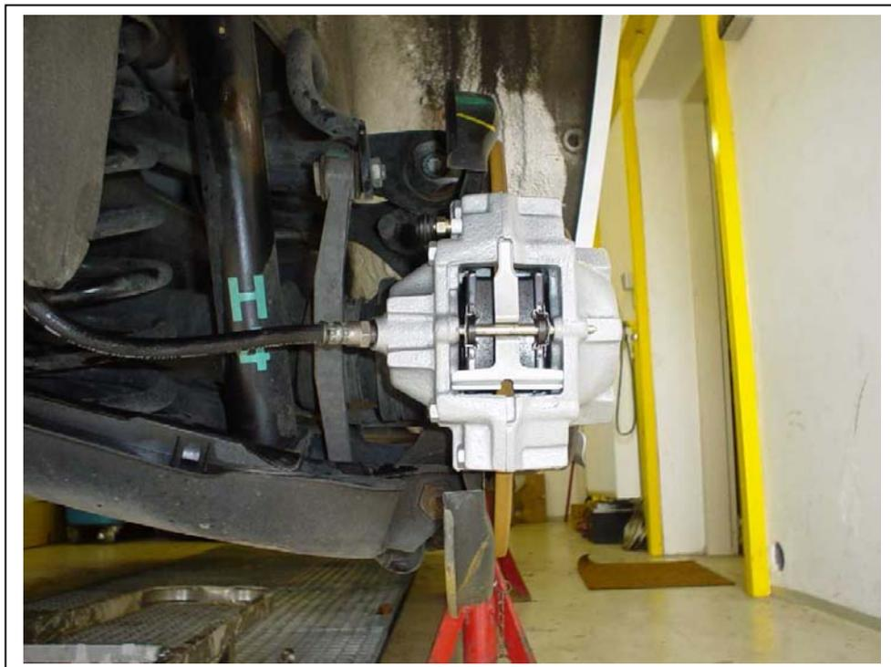
**Tip:** Ich habe die Kolben an der Auflagefläche der Bremsklötze dünn mit Kupferpaste bestrichen. Auch die Bremsklötze an den beiden Führungsflächen dünn mit Kupferpaste bestrichen um ein Quietschen der Bremse zu vermeiden.
