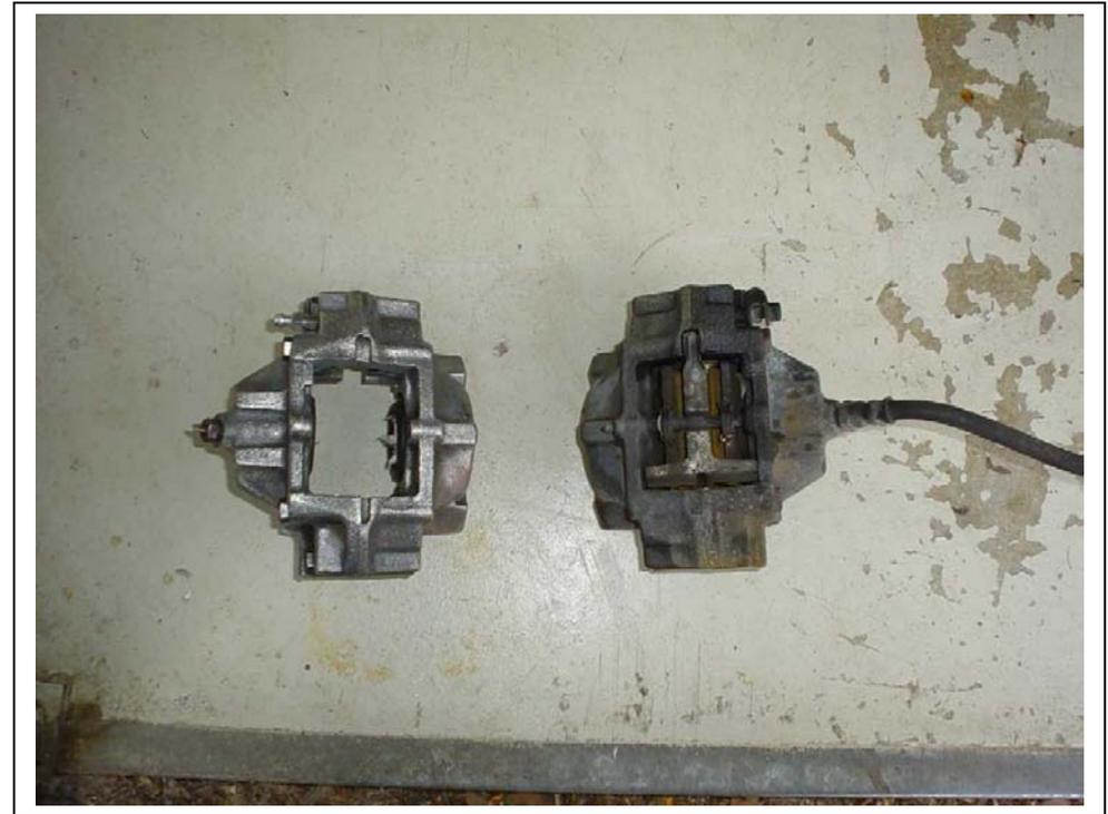
Um später die Bremssättel leichter zu montieren, habe ich alle Teile so sortiert, daß z.B. die Kolben wieder in die richtigen Zylinder kommen – also rechts und links bzw. innen und außen separat aufbewahrt und markiert.
