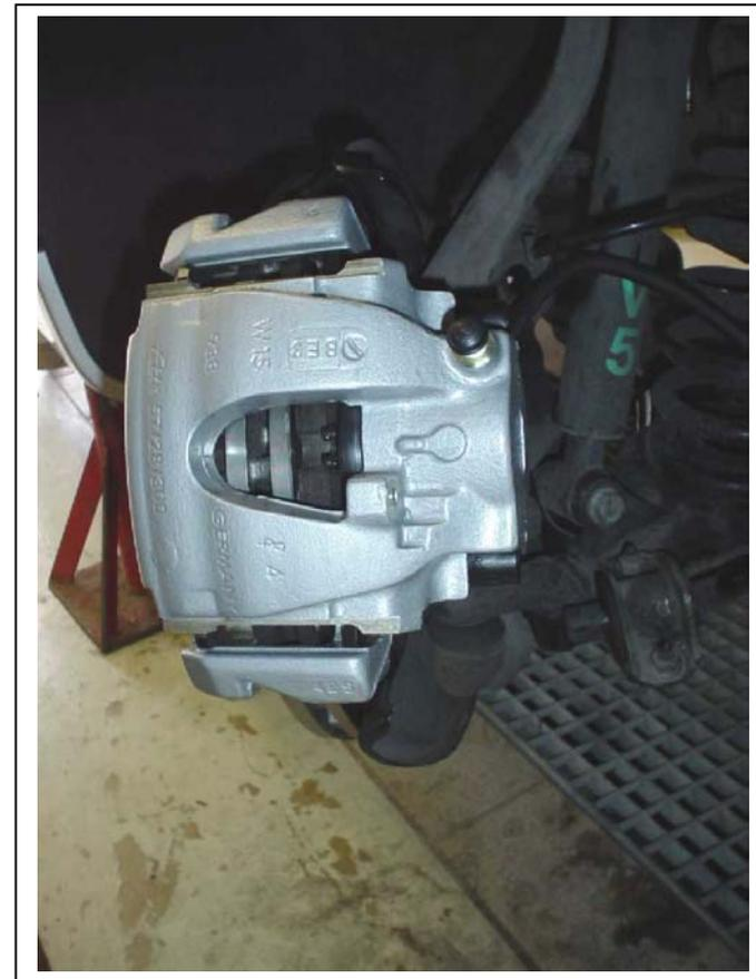
Links: Anschließend wird der Anschluß für den Verschleiß-Warnkontakt wieder angeschraubt. Danach kann der neue Warnkontakt eingesetzt und angeschlossen werden. Nun die Bremsleitung wieder anschließen und alle Verbindungen, Schrauben usw. nochmals auf korrekten Sitz prüfen!
