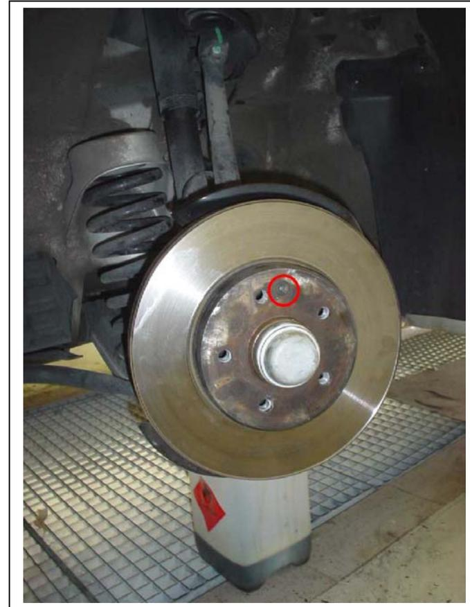
Links: Das Abschirmblech muß nicht erneuert werden, sollte aber gründlich gereinigt werden. Hierzu kann man den Bremsenreiniger oder etwas Kalt- bzw. Felgenreiniger verwenden.
