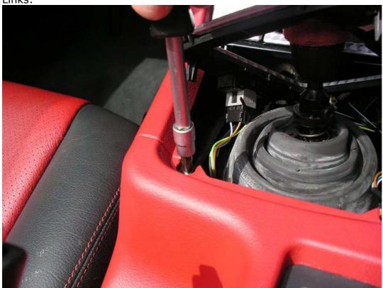
Hinten ist die Mittelkonsole mit zwei Muttern befestigt:
