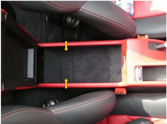
Den Stoff hochklappen, ggf. den kleinen Schlitzschraubendreher zu Hilfe nehmen. Beide Muttern mit dem 10er Steckschlüssel vollständig lösen.
