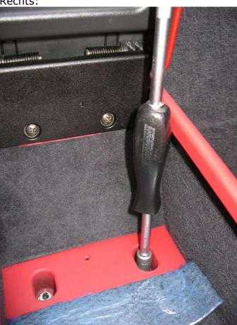
Wenn alle Schrauben los sind, kann man die Mittelkonsole bereits lösen. Dazu leicht hin und her wackeln.
