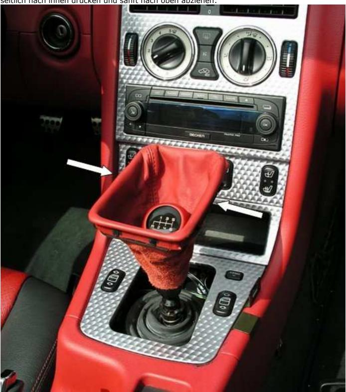
Danach die Blende um den Schalthebel lösen. Dazu diese gleichzeitig mit sanfter Gewalt nach hinten und oben ziehen:
