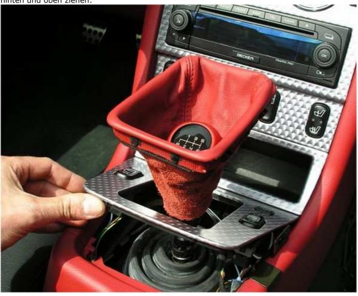
Jetzt die beiden Schrauben vorne an der Konsole rausdrehen. Rechts:
