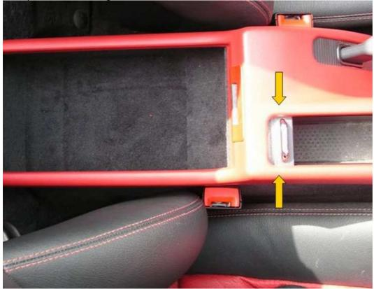
Schöner wäre es, wenn die LEDs von hinten nach vorne strahlen würden. Das wird aber mit dem Deckelrollo zu eng, ggf. bleibt das Rollo dann am Kabel hängen. Deshalb habe ich mich entschlossen, die LEDs seitlich anzubringen.
