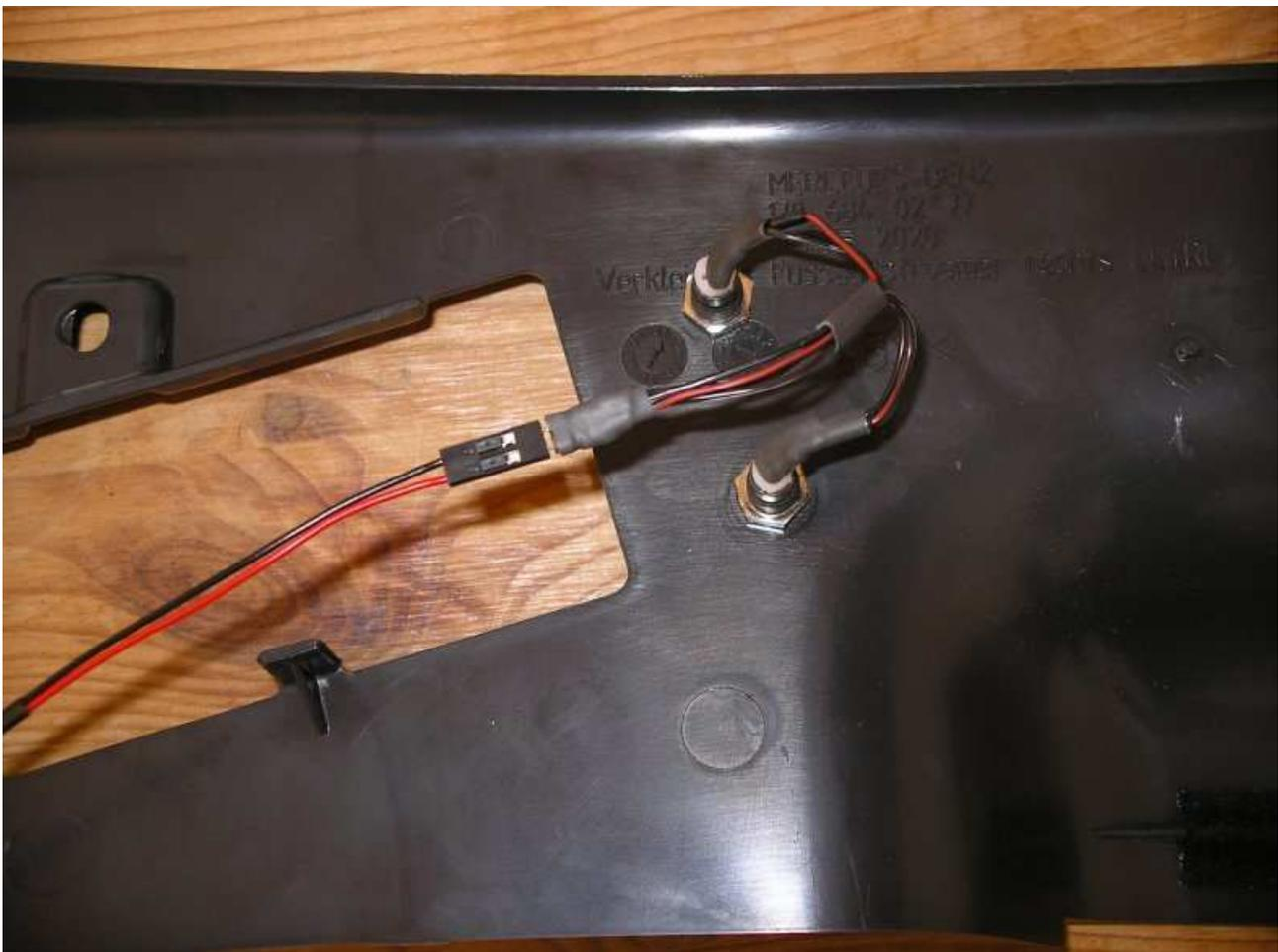
Den Strom für die LEDs kann man sich einfach von einem der Schalter klauen. Bei mir war es das Blau-Graue Kabel für die Nachtbeleuchtung. Masse kann man sich schön vor dem Schalthebel holen – da ist ein Massepunkt, eine Ringöse und 10er Nuss sind notwendig.
