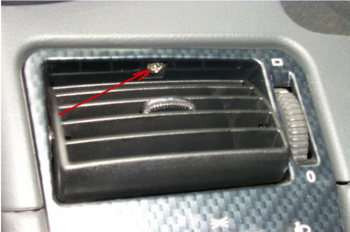
Schraube entfernen und Carbonabdeckung nach vorne herausziehen.
