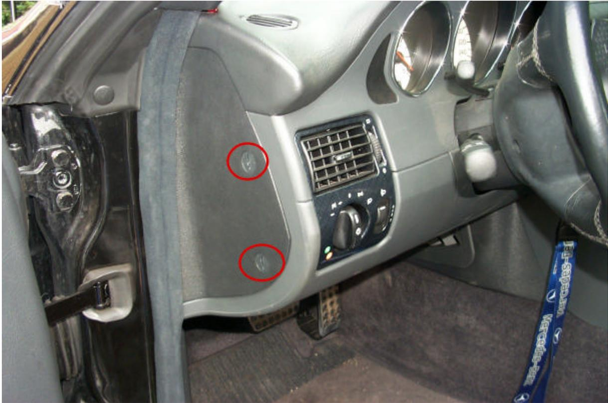
Die beiden Schrauben mit einem Geldstück lösen.
