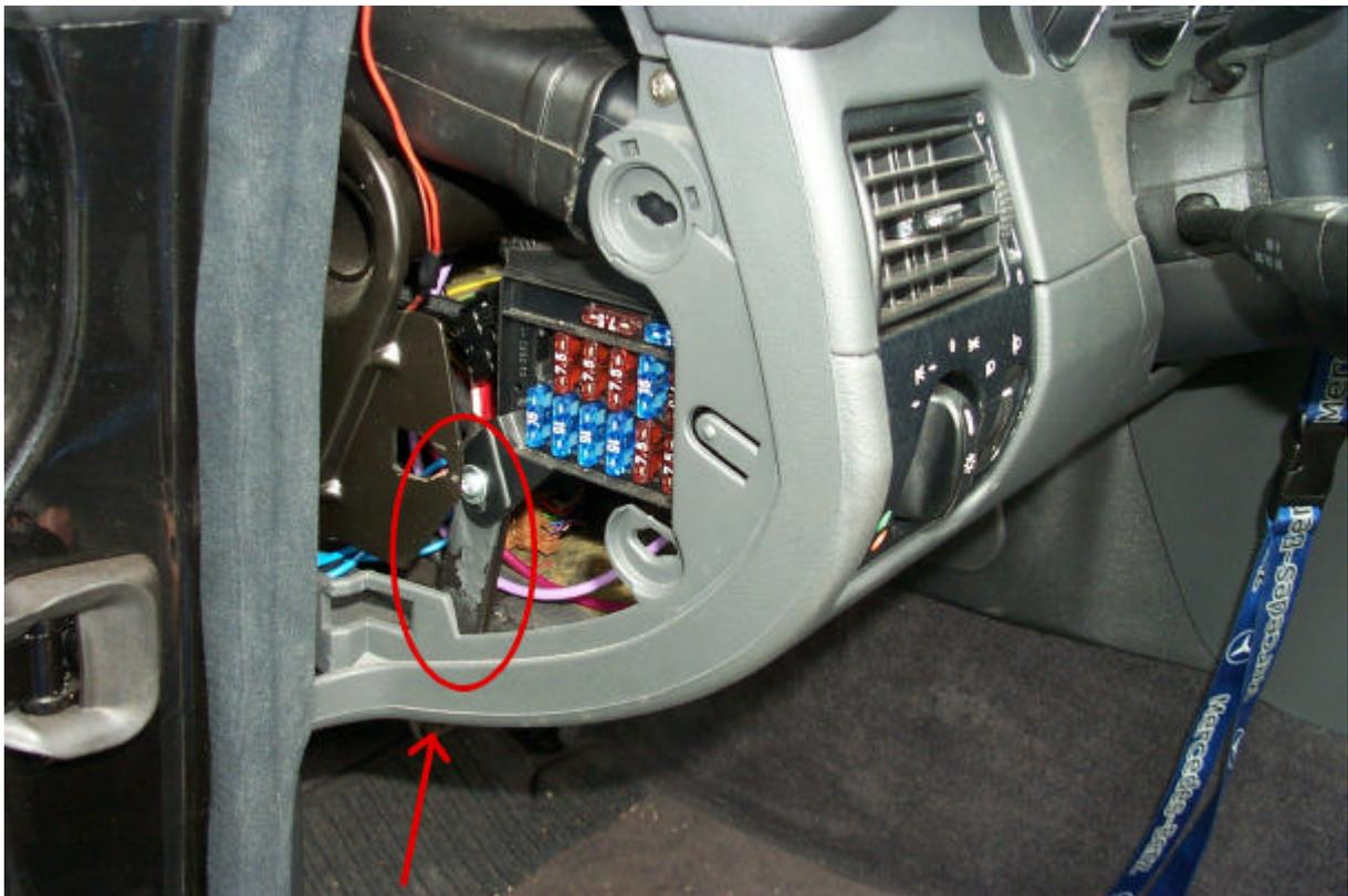
Schraube (roter Pfeil) lösen, um später das Lichtmodul nach hinten schieben zu können.
