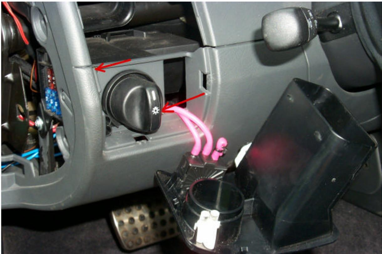
Schalter der Leuchtweitenregulierung ausclipsen und die zwei Schrauben (rote Pfeile) entfernen.
