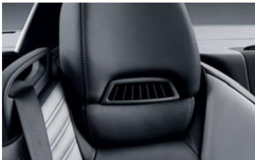
Der AIRSCARF wärmt auf Wunsch Kopf- und Nackenbereich von Fahrer und Beifahrer.
